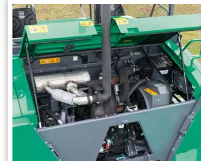
**Le puissant** moteur diesel fournit 116 kW à seulement 2 000 tr/min.
