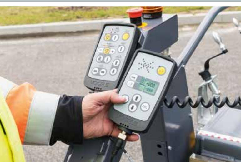
**Le nouveau système de conduite ErgoBasic** a été conçu sur la base du système de conduite éprouvé ErgoPlus des grands finisseurs VÖGELE, et spécialement adapté aux besoins et exigences des utilisateurs des finisseurs de la Classic Line.
