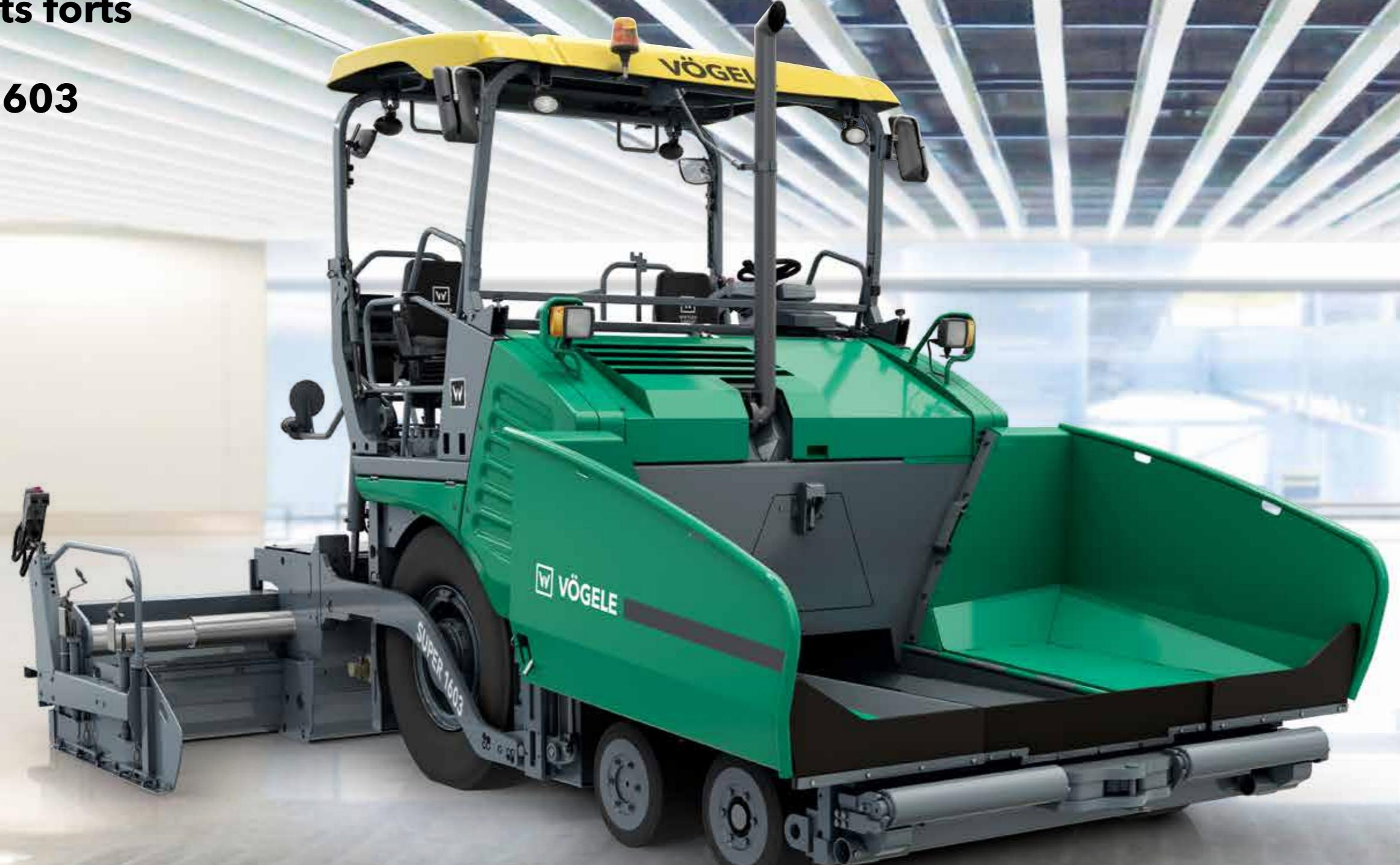
**Performant et efficace** grâce au moteur de 116 kW
