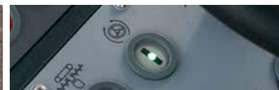
**Extrême maniabilité** grâce au « Pivot Steer » : En activant le frein directionnel « Pivot Steer », la roue arrière intérieure au virage est automatiquement freinée par commande hydraulique, ce qui réduit le rayon de braquage extérieur à seulement 3,5 m lors du repositionnement et de la pose.
