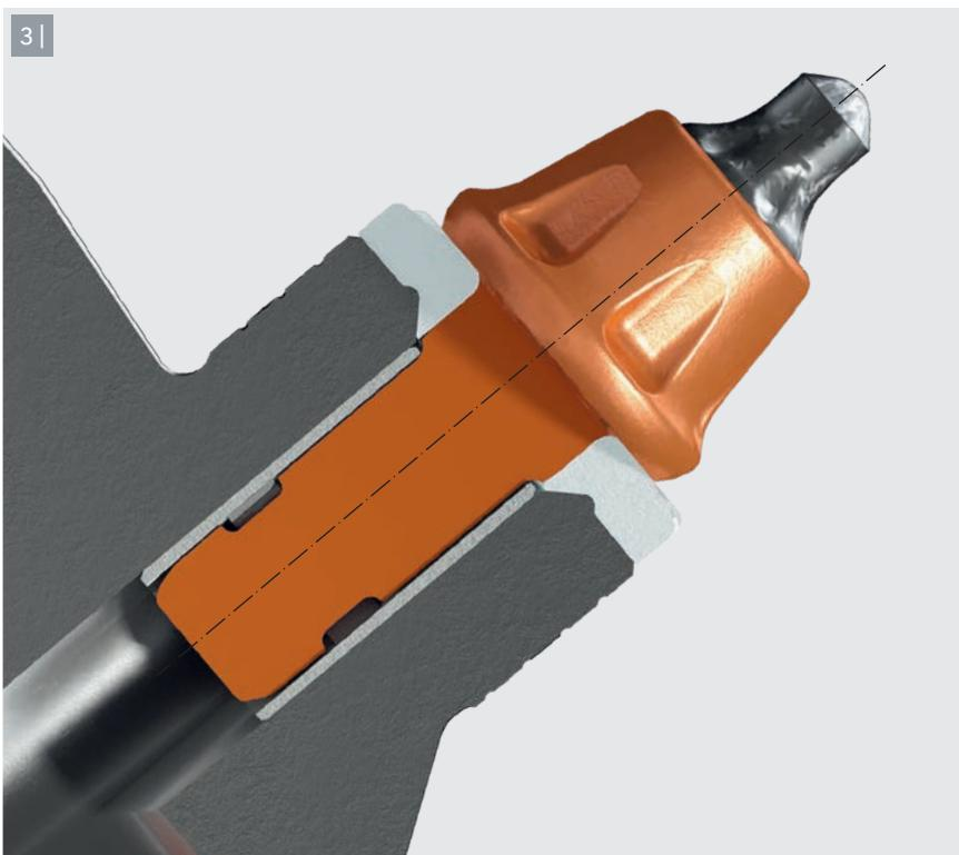
**3 |** La svasatura di centraggio presente sul nuovo portadente ottimizza, unitamente al nuovo dente a codolo cilindrico, il comportamento rotazionale per una ridotta usura.
