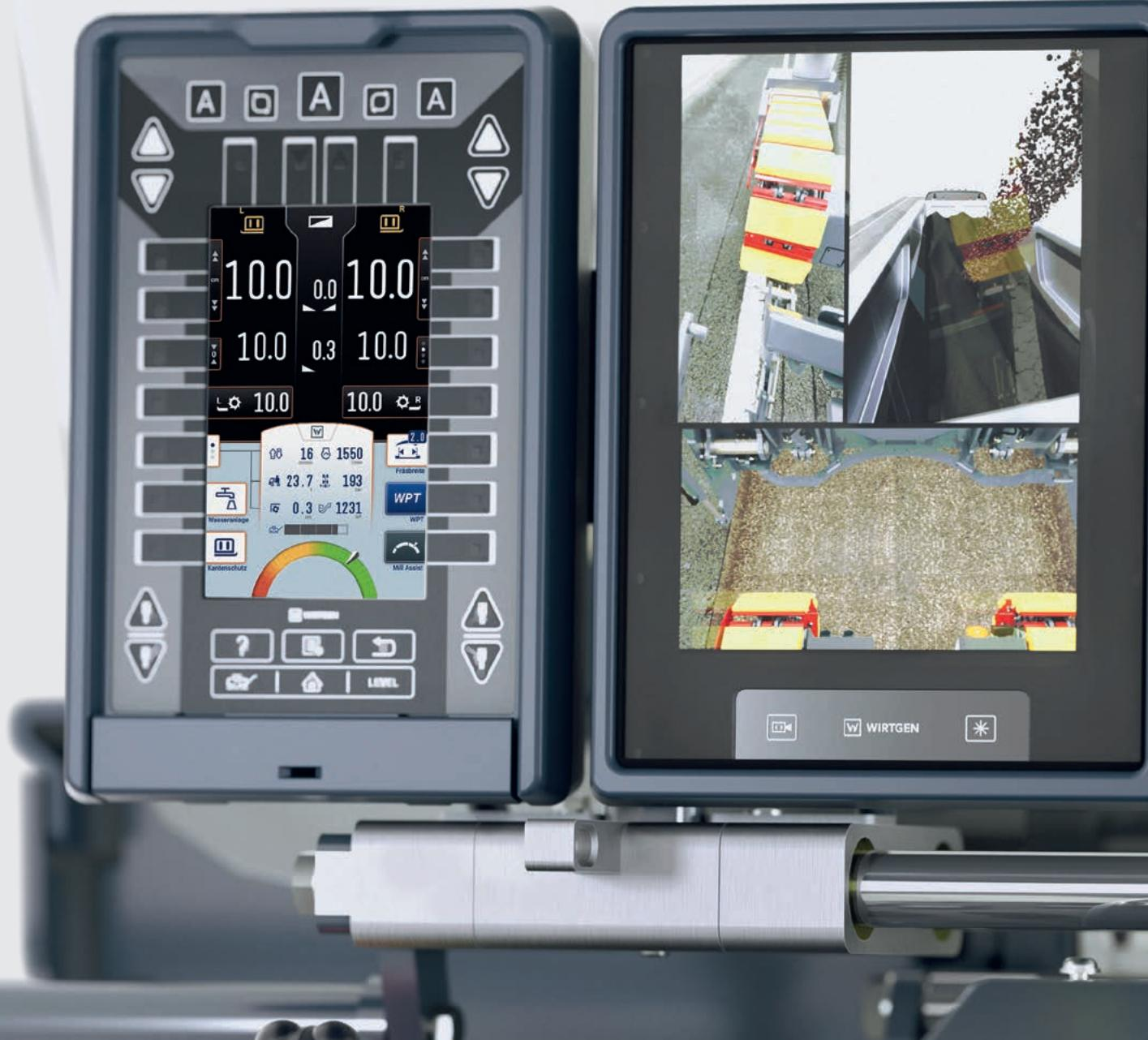
**1 |** Pannello di comando da 10" con schermo diviso per la visualizzazione simultanea delle immagini riprese da più telecamere.
