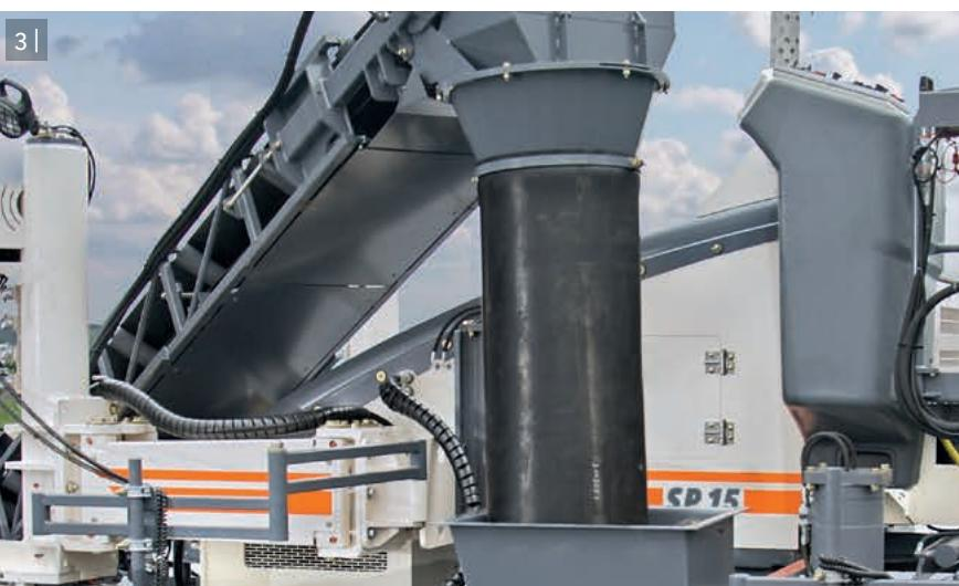
2 | Unos cilindros hidráulicos permiten hacer girar el dispositivo de alimentación y ajustarlo en dirección longitudinal y conforme al ángulo de inclinación.
