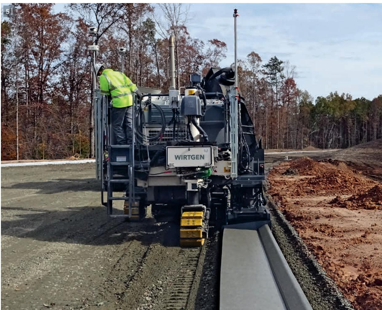
4 | Ajuste hidráulico de la altura de hasta 1000 mm (adicionalmente de forma mecánica: 280 mm).
