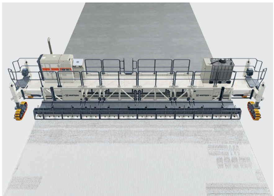
Längsbürsten und -sprühen erweitert das Spektrum zur Erstellung verschiedener Oberflächenstrukturen.
