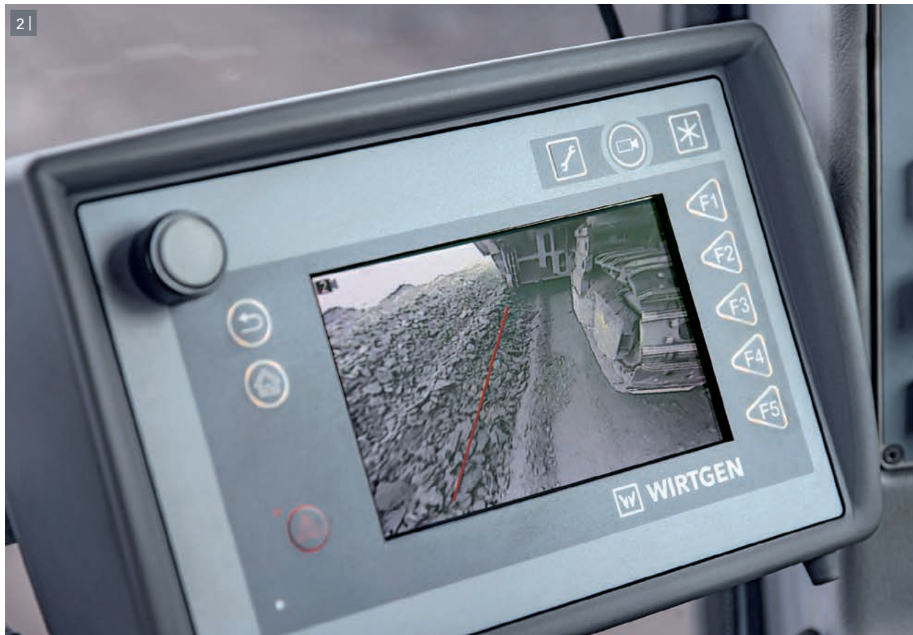
2 | Schnelles Rangieren per Rückfahrkamera erhöht die Produktivität der Maschine.
