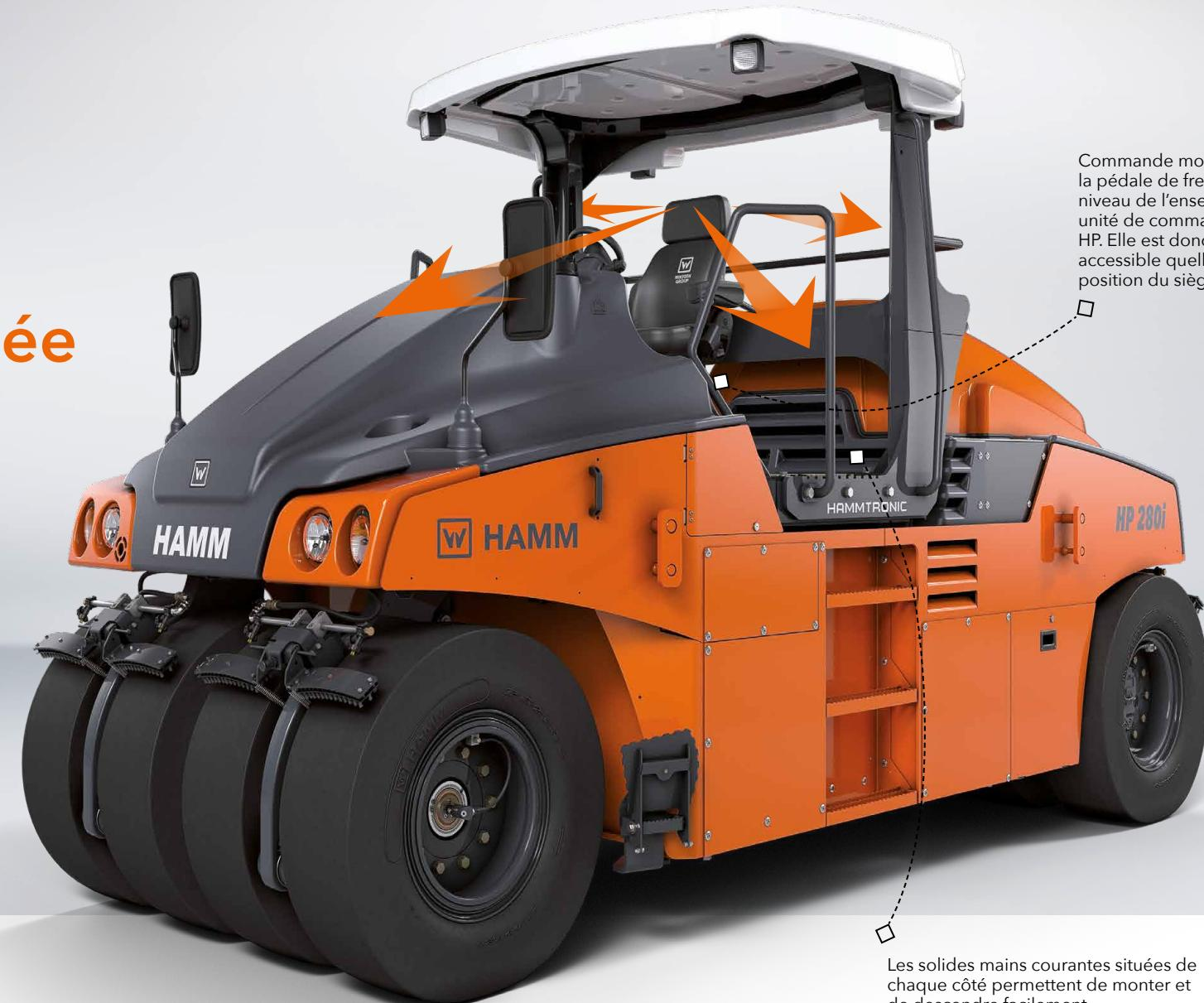
Commande moderne et sûre : la pédale de frein se trouve au niveau de l'ensemble siège-unité de commande dans le HP. Elle est donc parfaitement accessible quelle que soit la position du siège.
