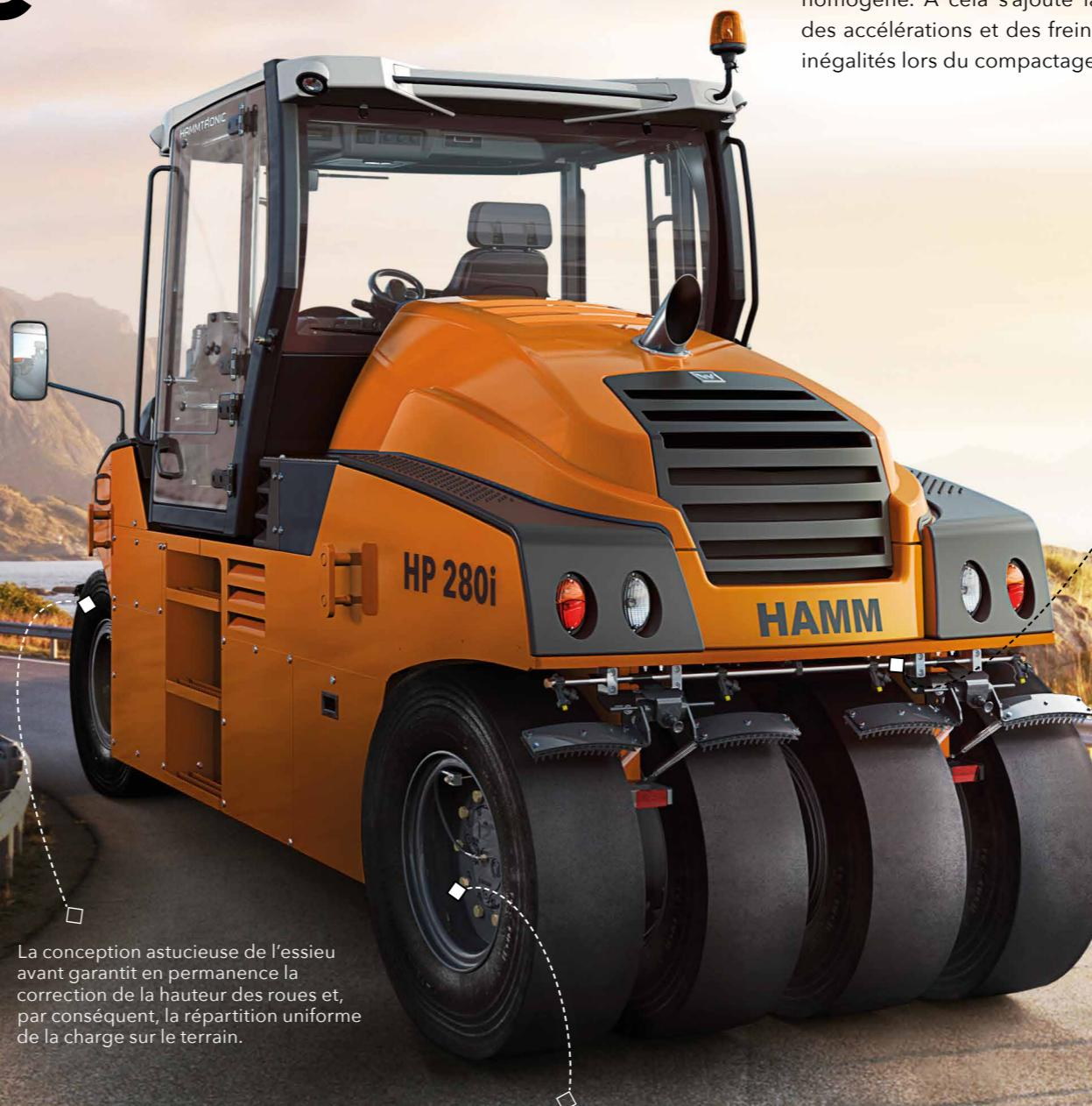
La conception astucieuse de l'essieu avant garantit en permanence la correction de la hauteur des roues et, par conséquent, la répartition uniforme de la charge sur le terrain.
