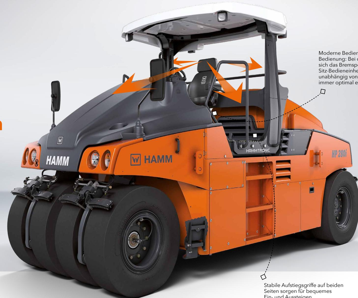
Moderne Bedienung – sichere Bedienung: Bei der HP befindet sich das Bremspedal an der Sitz-Bedieneinheit. Damit ist es unabhängig von der Sitzposition immer optimal erreichbar.
