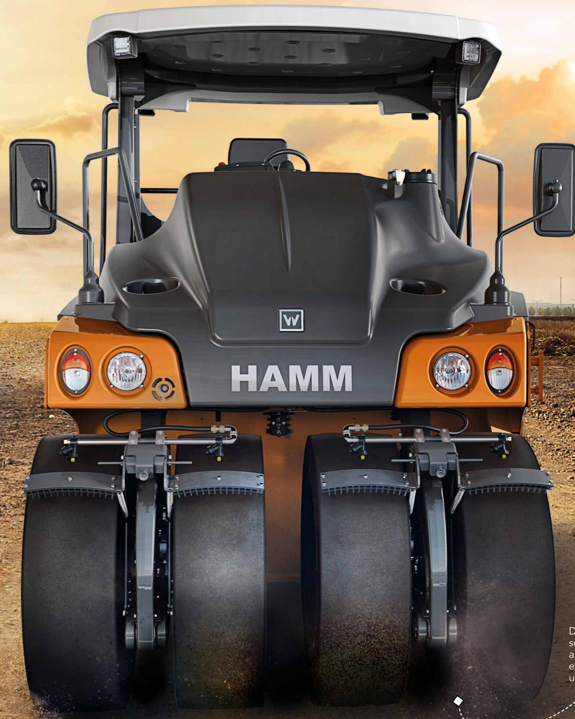
Die Anti-Schlupf-Regelung sorgt für optimale Traktion auf unebenem Gelände ebenso wie auf Flächen unterschiedlicher Temperatur.
