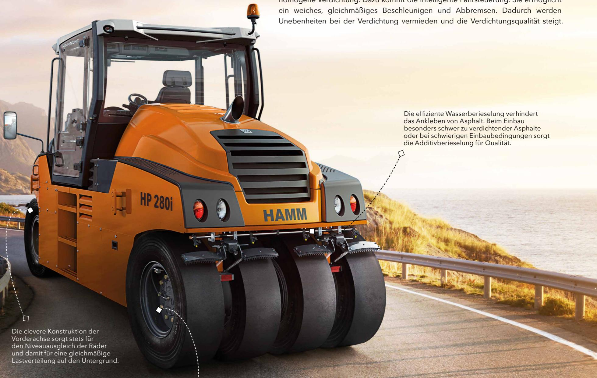
Die clevere Konstruktion der Vorderachse sorgt stets für den Niveauegleich der Räder und damit für eine gleichmäßige Lastverteilung auf den Untergrund.
