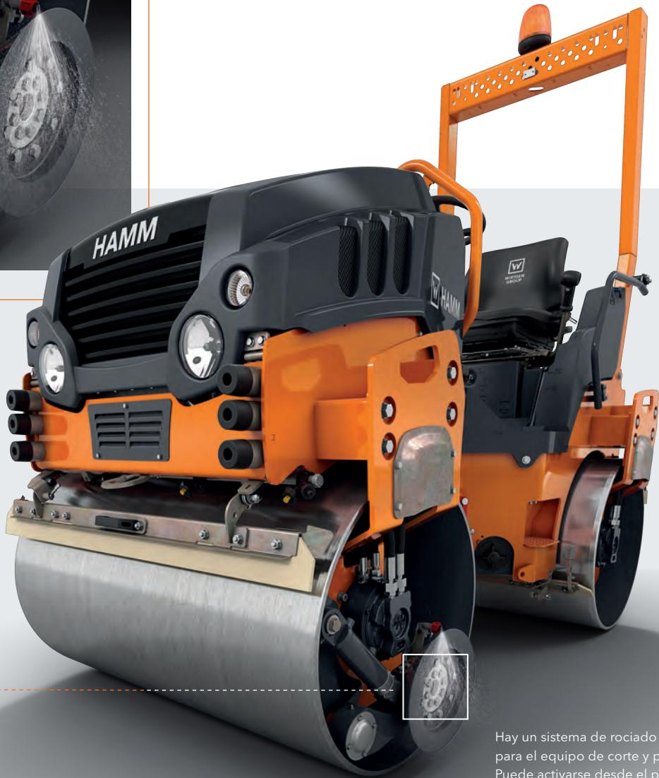
Hay un sistema de rociado activable por separado para el equipo de corte y presión de bordes. Puede activarse desde el puesto del conductor con un interruptor.
