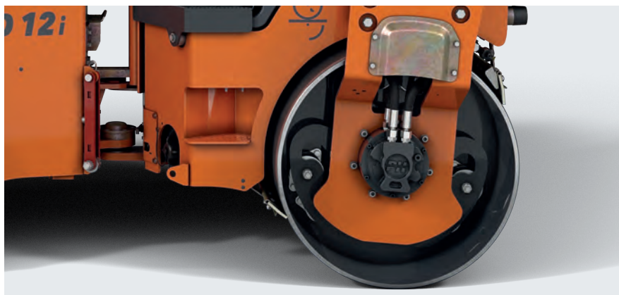
Viel Seitenfreiheit für die Arbeit entlang von Bordsteinkanten durch weit hochgezogene Seitenbleche.
