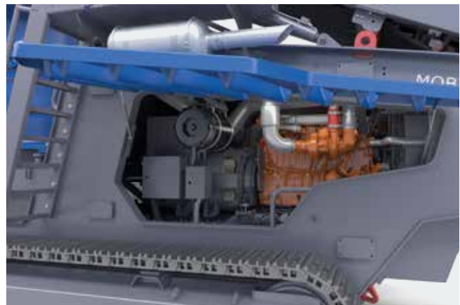
> MCO 11 PRO - komfortabler Zugang zum Motorraum, Betankung vom Boden aus möglich
