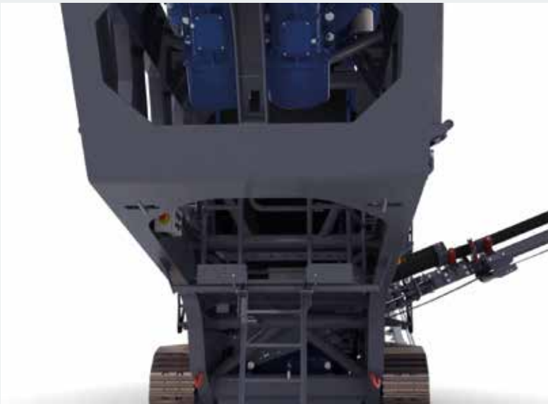
> MC 120(i) PRO - Cambio cómodo de la superficie de cribado gracias a la buena accesibilidad
