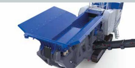
Selbstverriegelnde Trichterwände - für schnelle und sichere Inbetriebnahme
