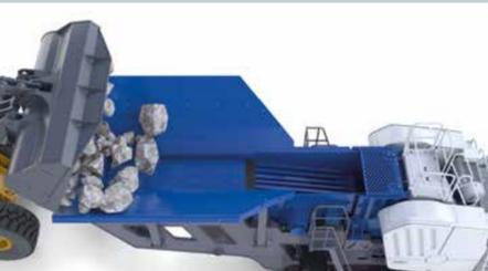
Einfache Beschickung per Radlader möglich, Beladungsbreite rückseitig 4 m
