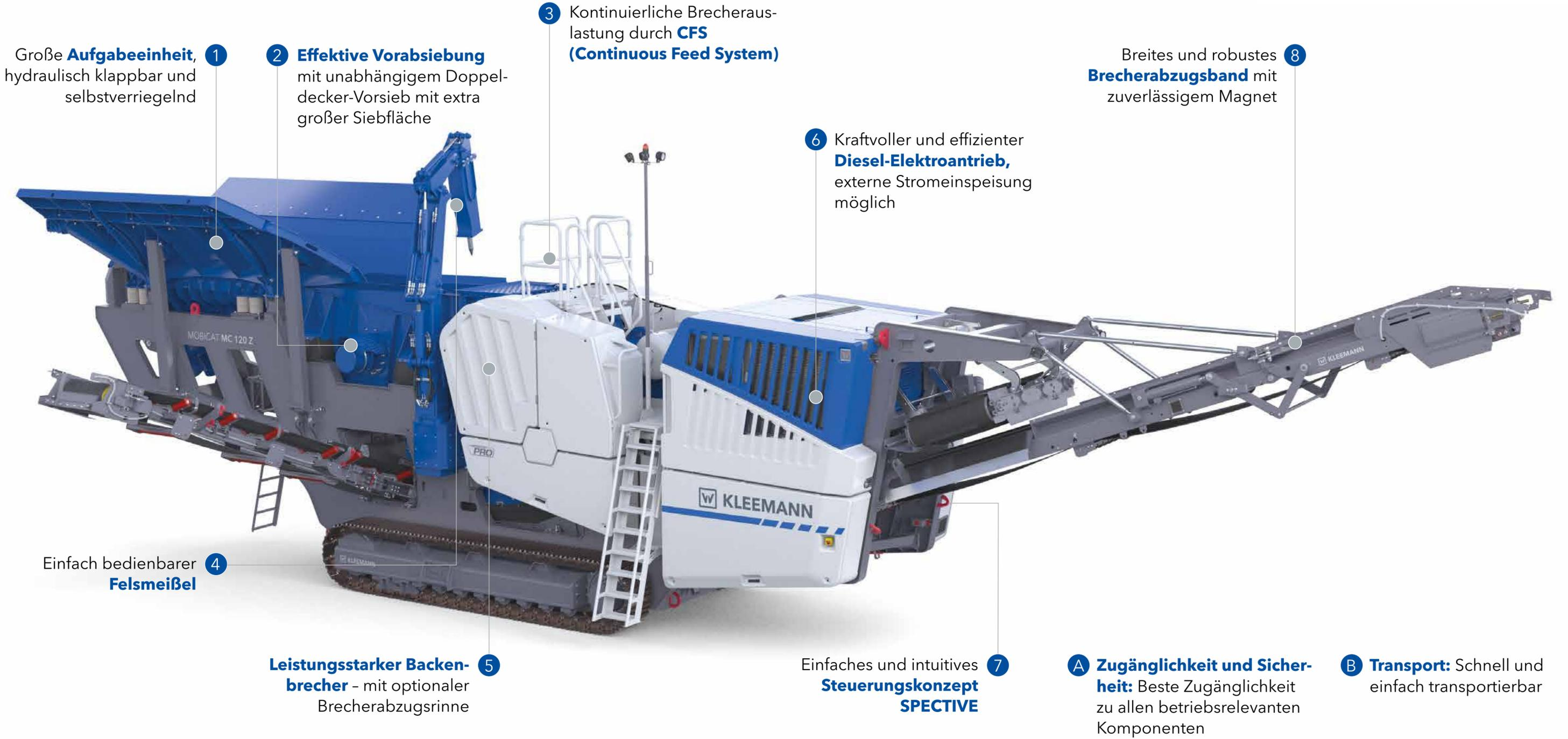
1 Große **Aufgabereinheit**, hydraulisch klappbar und selbstverriegelnd
