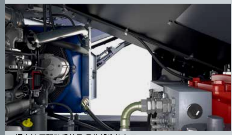
通向液压驱动系统及保养部件的入口
