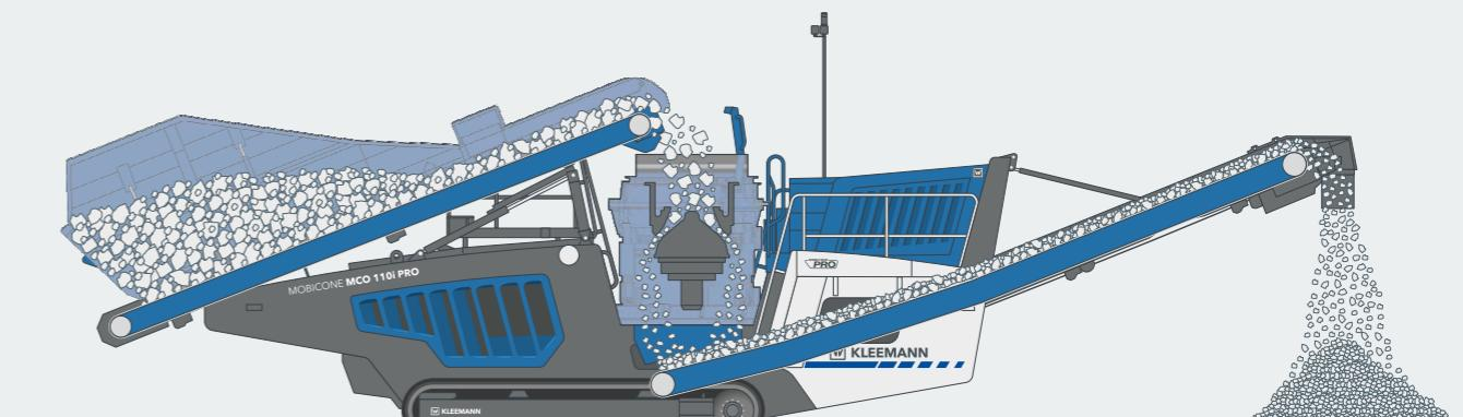
Die MOBICONE MCO 110(i) PRO verfügt über einen einfachen Schiebemechanismus der Aufgabeeinheit, der die Maschine in eine kompakte Transportposition bringt und ein schnelles Setup ermöglicht. Durch den Schiebemechanismus kann zudem die Materialabwurfparabel in den Brecher einfach angepasst werden - für eine optimale Beschickung.
