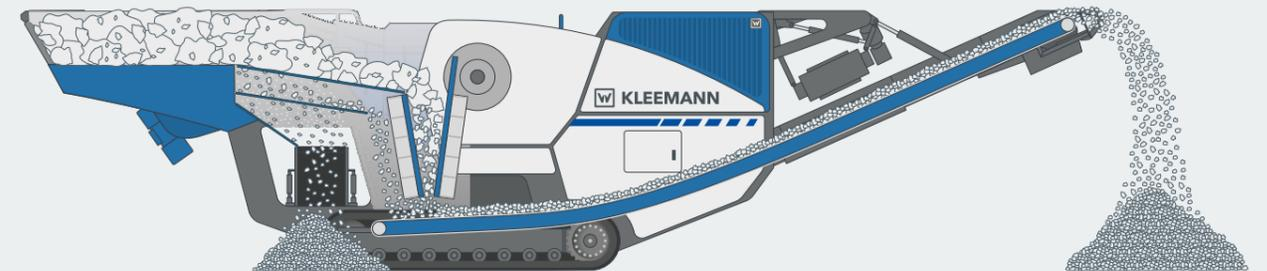
Mit ihrem geringen Gewicht und den sehr kompakten Abmessungen kann die MOBICAT MC 100(i) EVO direkt vor Ort zum Einsatz kommen - selbst auf engen oder schlecht erreichbaren Baustellen in Innenstädten. Auch für kurze Rüstzeiten wird gesorgt: Durch die in das Chassis integrierte Aufgabeeinheit entfällt das Auf- und
