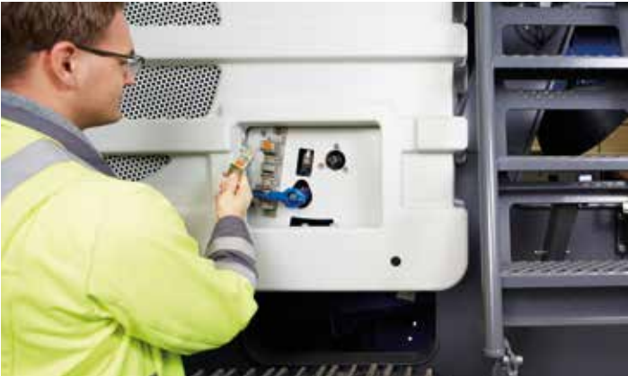
> Se a chave for retirada, o rotor permanece bem protegido.
