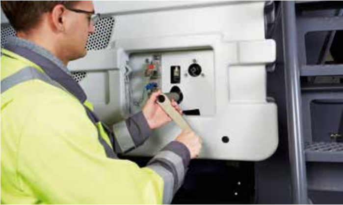
> O dispositivo de bloqueio e rotação do rotor está liberado e pode ser movido com uma manivela.
