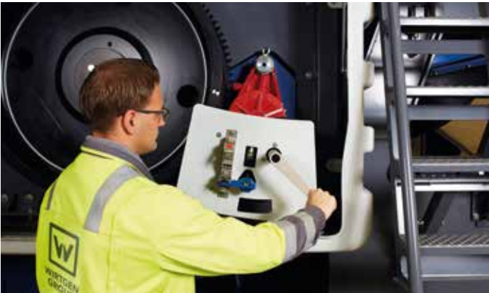
> Com a manivela, o rotor pode ser girado sem perigo e colocado na posição ideal para a substituição das travessas de impacto.
