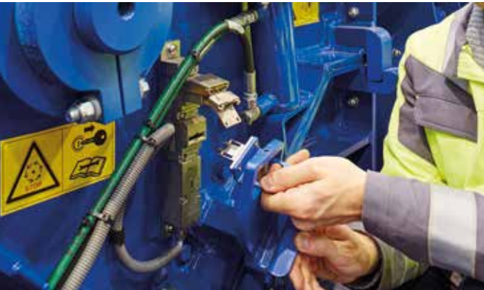
> A carcaça do britador é aberta com uma chave especial. Uma vez aberta, a chave não pode ser retirada e o material pode ser removido com segurança.
