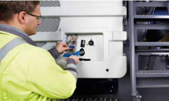
> Inserir o elemento de comando na estação de liberação; o rotor está bloqueado com segurança e a chave liberada para outros passos.
