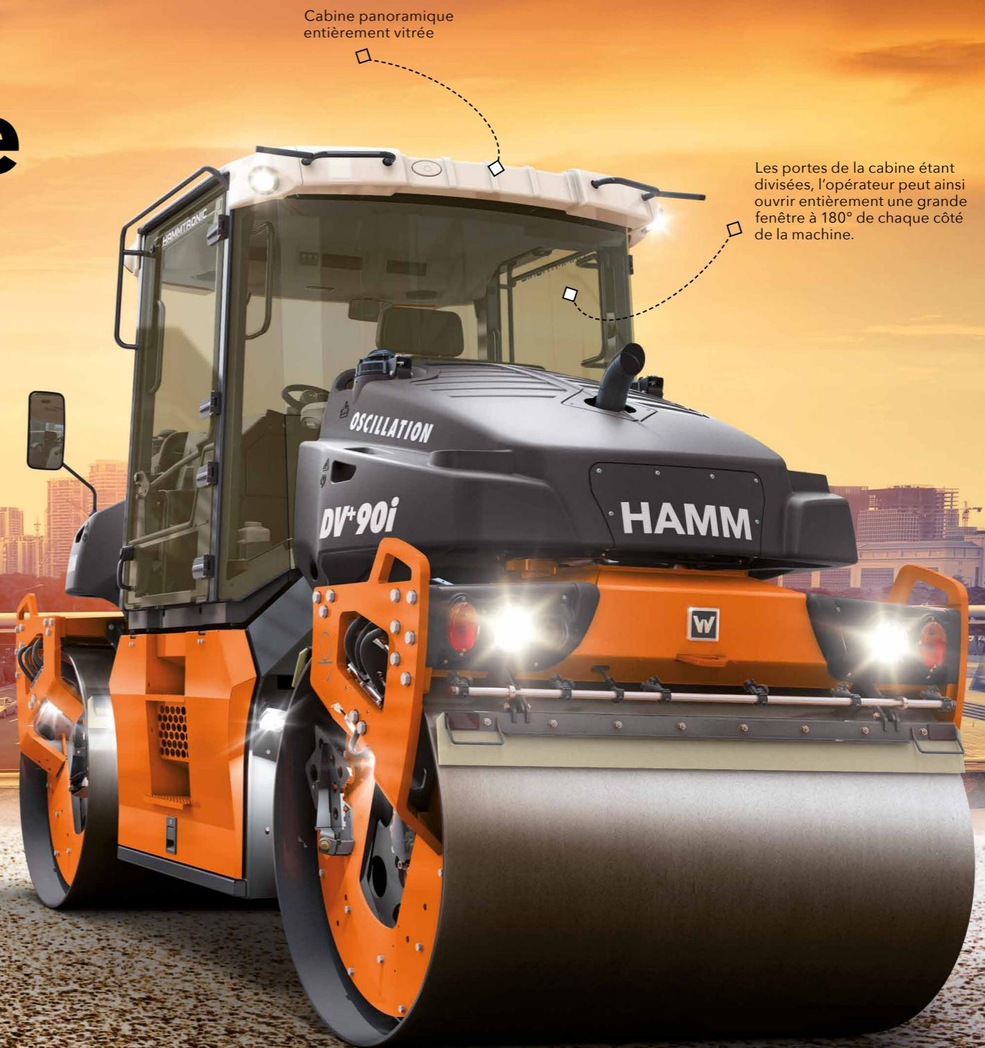
Grâce à une cabine panoramique entièrement vitrée et une large fenêtre au niveau du plancher, le poste de conduite des modèles de la série DV+ offre aux opérateurs une vue parfaite sur le chantier et les cylindres. Depuis les côtés de la cabine, ils ont en outre une excellente vue sur les bords de cylindres et sur le dispositif de pression et de découpe des bordures.
