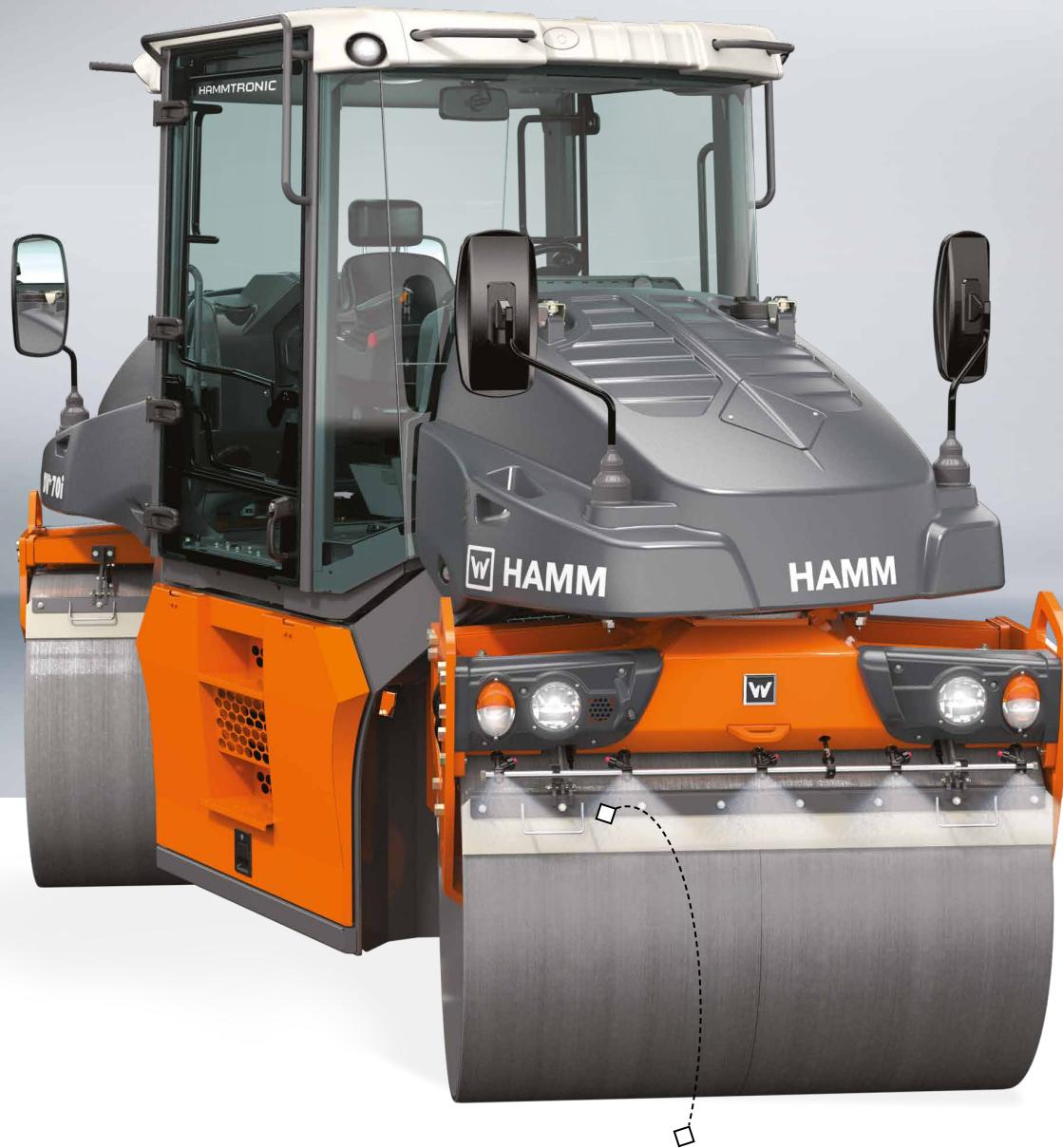
De son siège, l'opérateur peut sélectionner avec précision l'un des 5 niveaux d'arrosage. La quantité d'eau s'adapte automatiquement à la vitesse.
