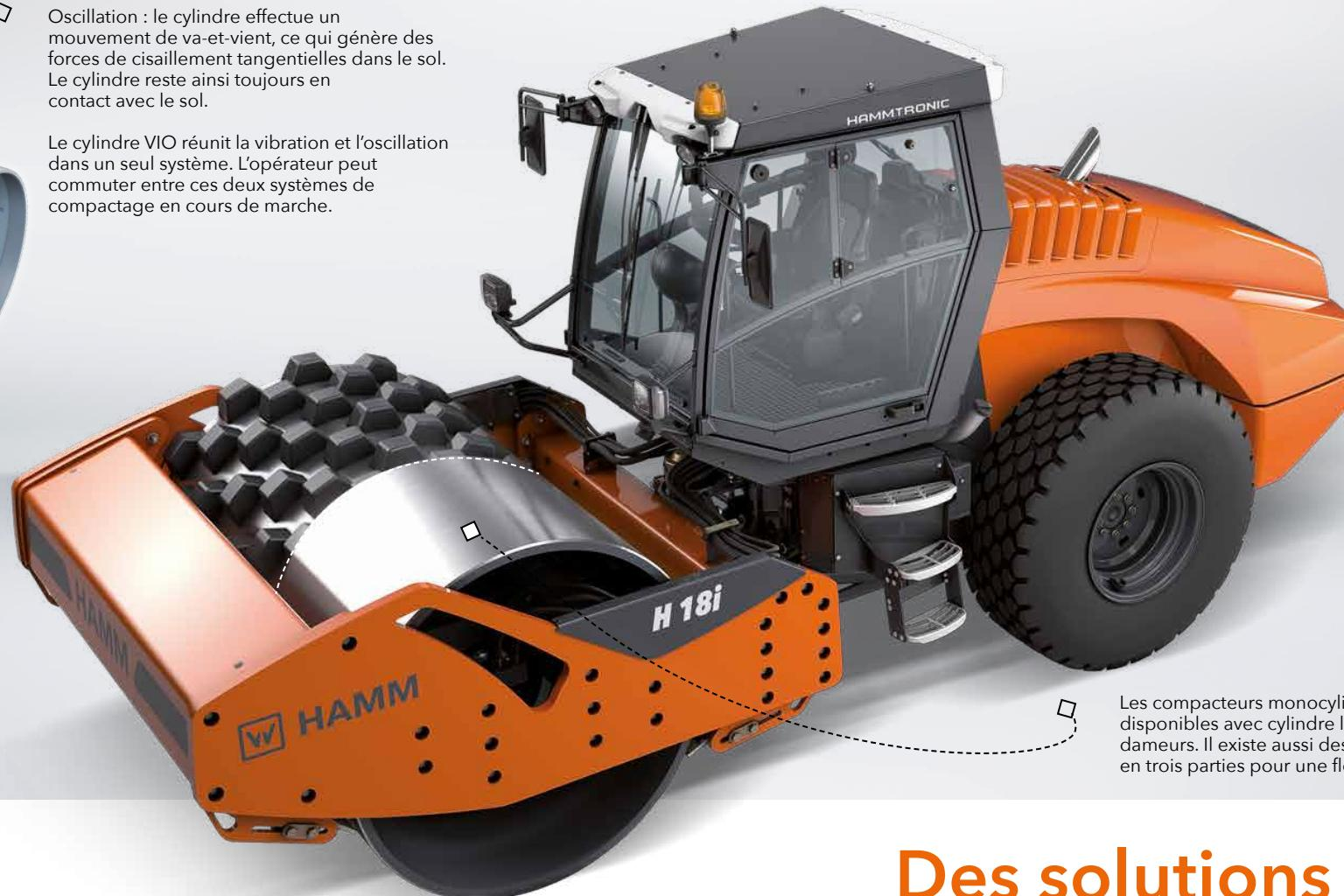
Les compacteurs monocylindres de la série H sont disponibles avec cylindre lisse ou avec cylindre à pieds dameurs. Il existe aussi des coques de pieds dameurs en trois parties pour une flexibilité maximale.
