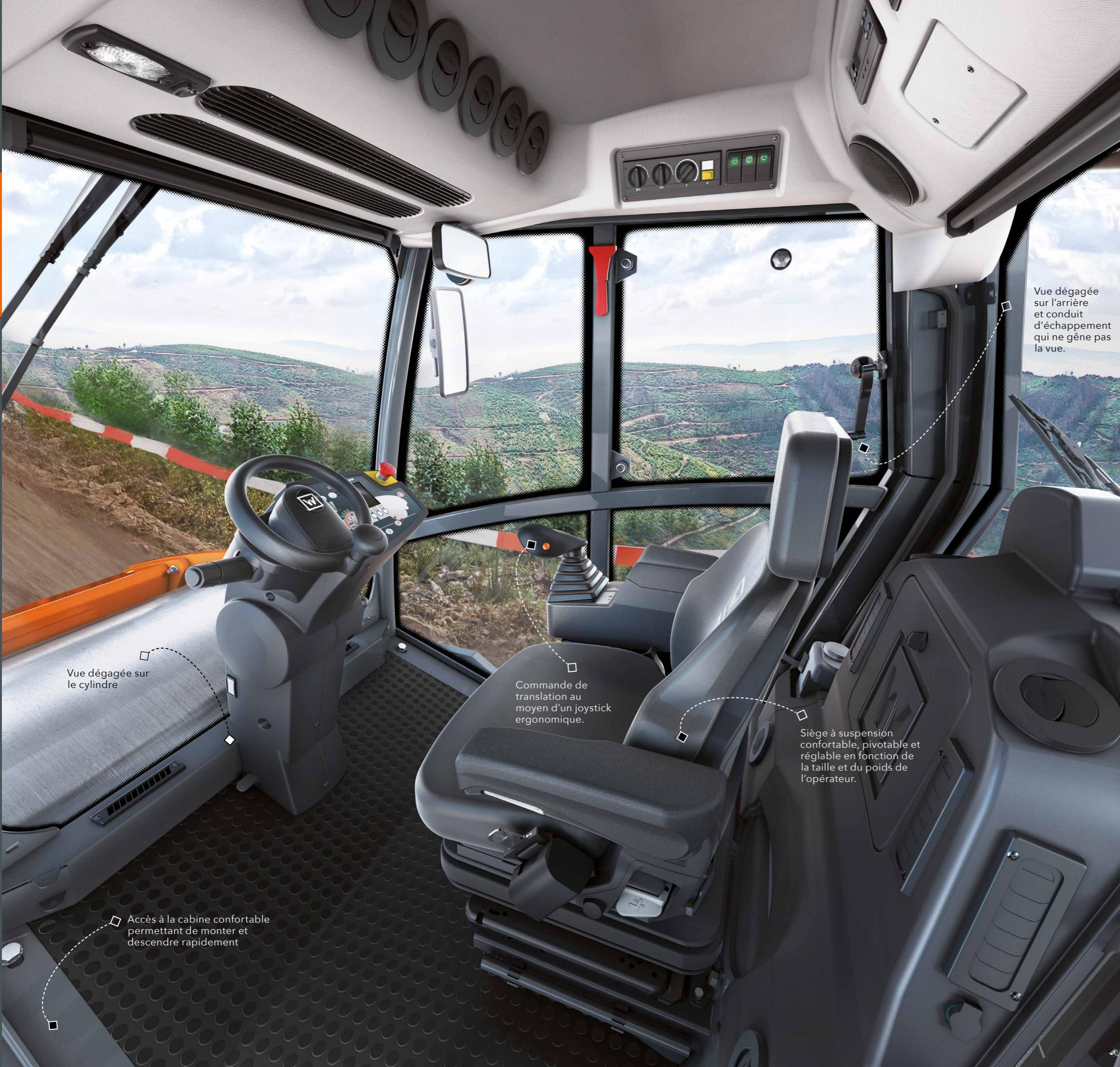
L'excellente visibilité de la plateforme de conduite ergonomique permet de manœuvrer les compacteurs de manière simple et sûre.
