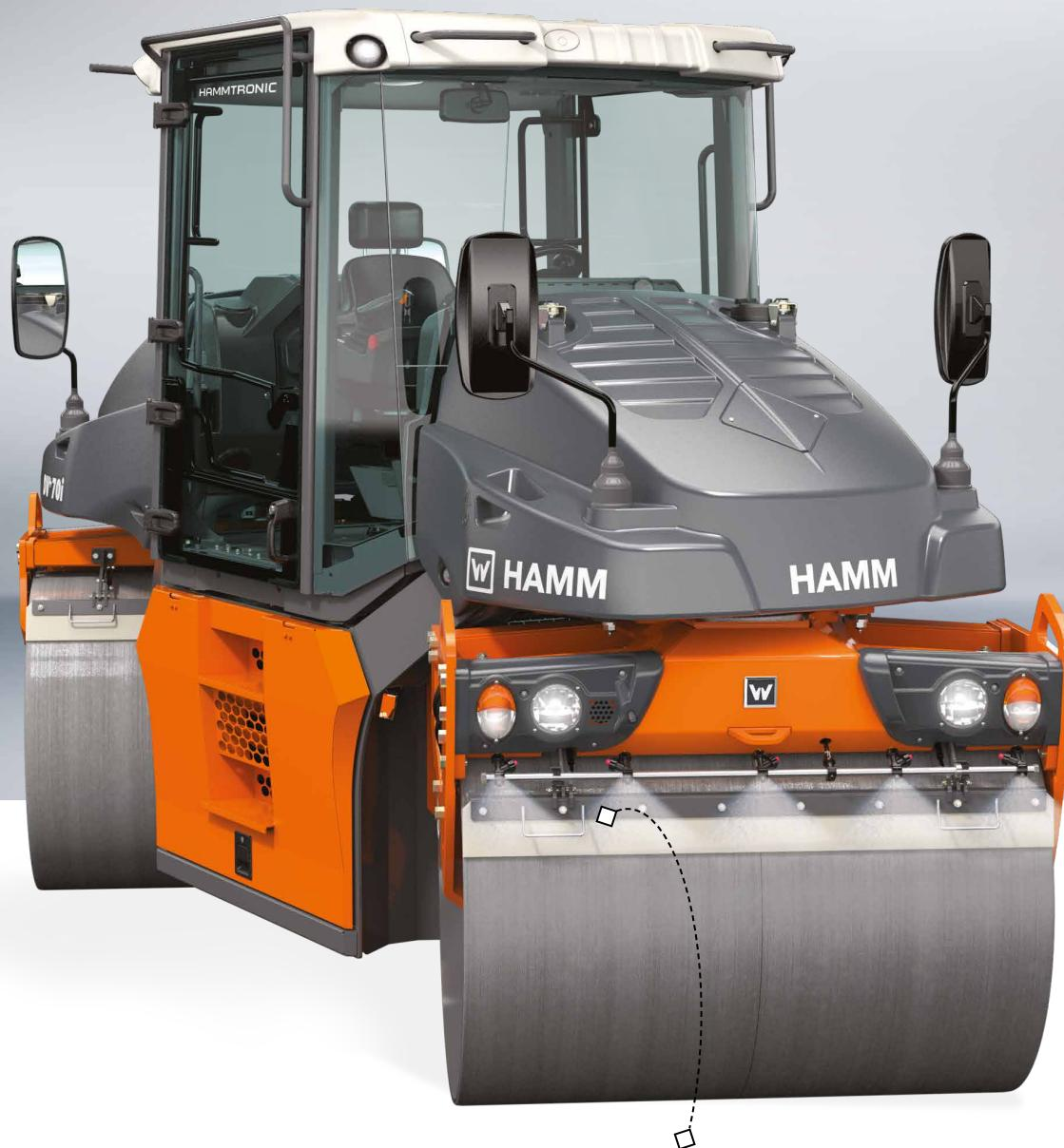
Die Wassermenge kann sehr fein in 5 Stufen vom Fahrersitz aus eingestellt werden. Die Regelung erfolgt automatisch abhängig von der Geschwindigkeit.
