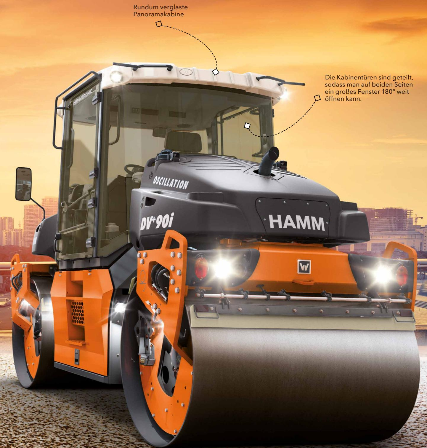
Der Fahrerstand der Serie DV+ bietet den Walzenfahrern aus der rundum verglasten Panoramakabine und den breiten Sichtfenstern im Boden eine perfekte Sicht auf das komplette Arbeitsumfeld inklusive der Bandagen. Vom Kabinenrand haben sie außerdem einen hervorragenden Blick auf die Bandagenkanten sowie das Kantenandrück- und Schneidgerät.
