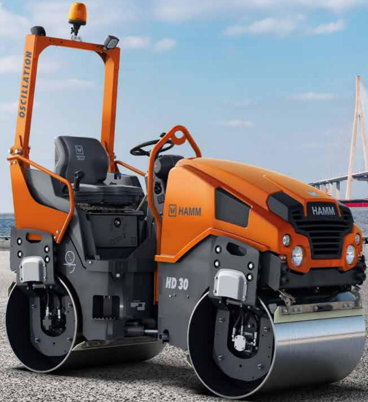
HD 系列小型压路机的驾驶员对钢轮侧面边缘, 机器前后工作区域及两侧区域均具有理想的视野。如此完美的视野主要源于优秀的设计理念: 纵向布置发动机。由此促成了流线型且为蜂腰式结构的发动机罩壳。
