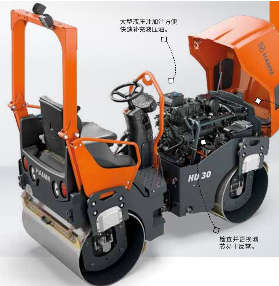
得益于大型加注口和易于接近的保养点，压路机的维护保养能够非常简单且快速的完成。
