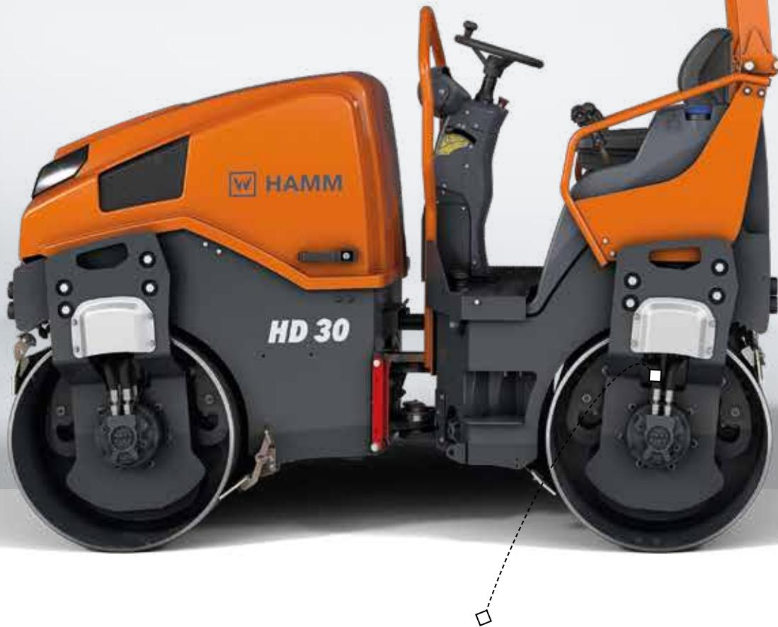
沿路缘石压实作业时间，可提升的侧板使机器拥有很高的侧面离地间隙。
