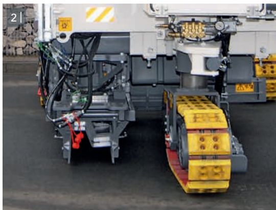
2 | 紧凑的外形尺寸: 当处于缩回状态时, 摊铺模具能够在运输过程中保持在适当的位置。
