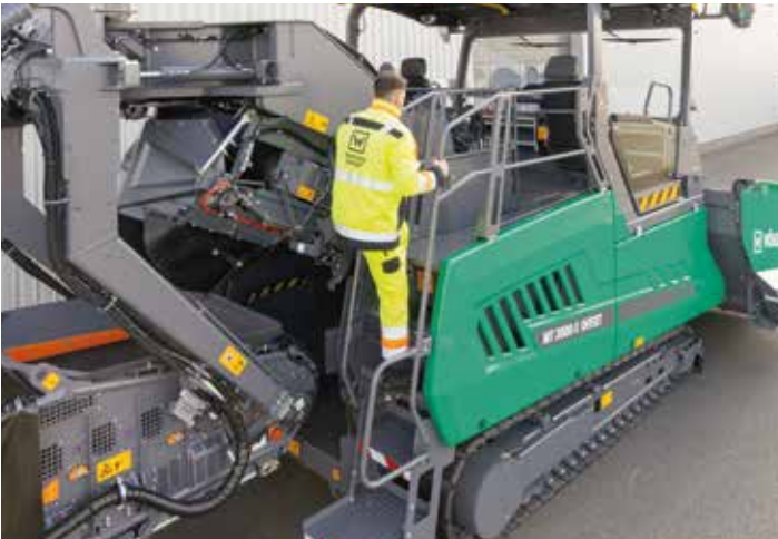
O passadiço e a subida confortável da permitem acesso seguro e prático à plataforma do operador.
