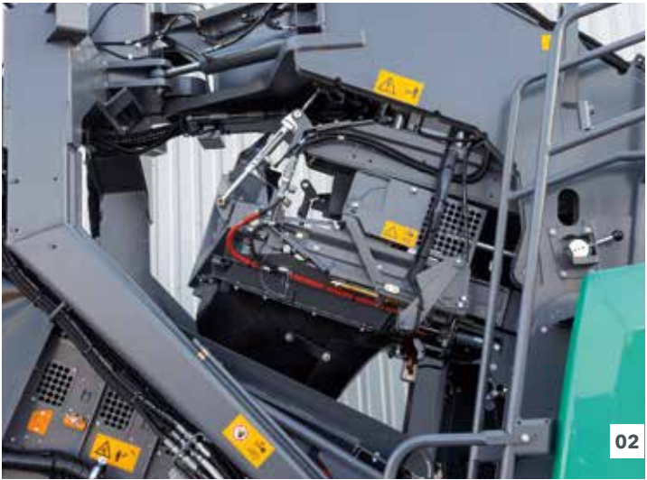
01 Tampas de manutenção de fácil acesso 02 Tremonha de transferência rebatível
