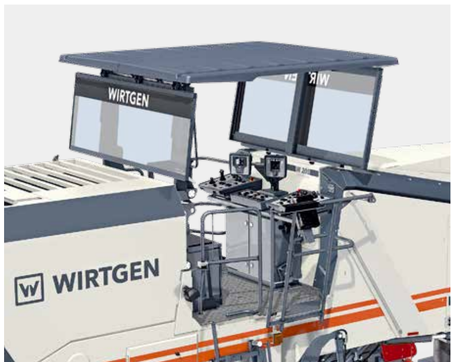
大型驾驶台配有整套减震安装装置
