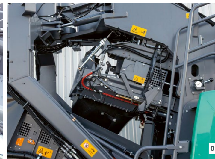
01 Panneaux ouvrants facilement accessibles 02 Trémie de transfert rabattable
