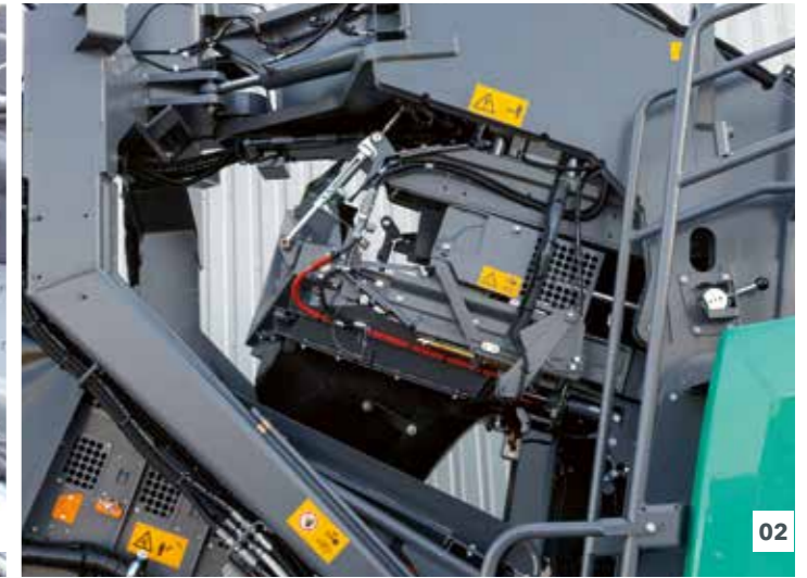
01 Compuertas de mantenimiento de fácil acceso 02 Tolva de transferencia abatible
