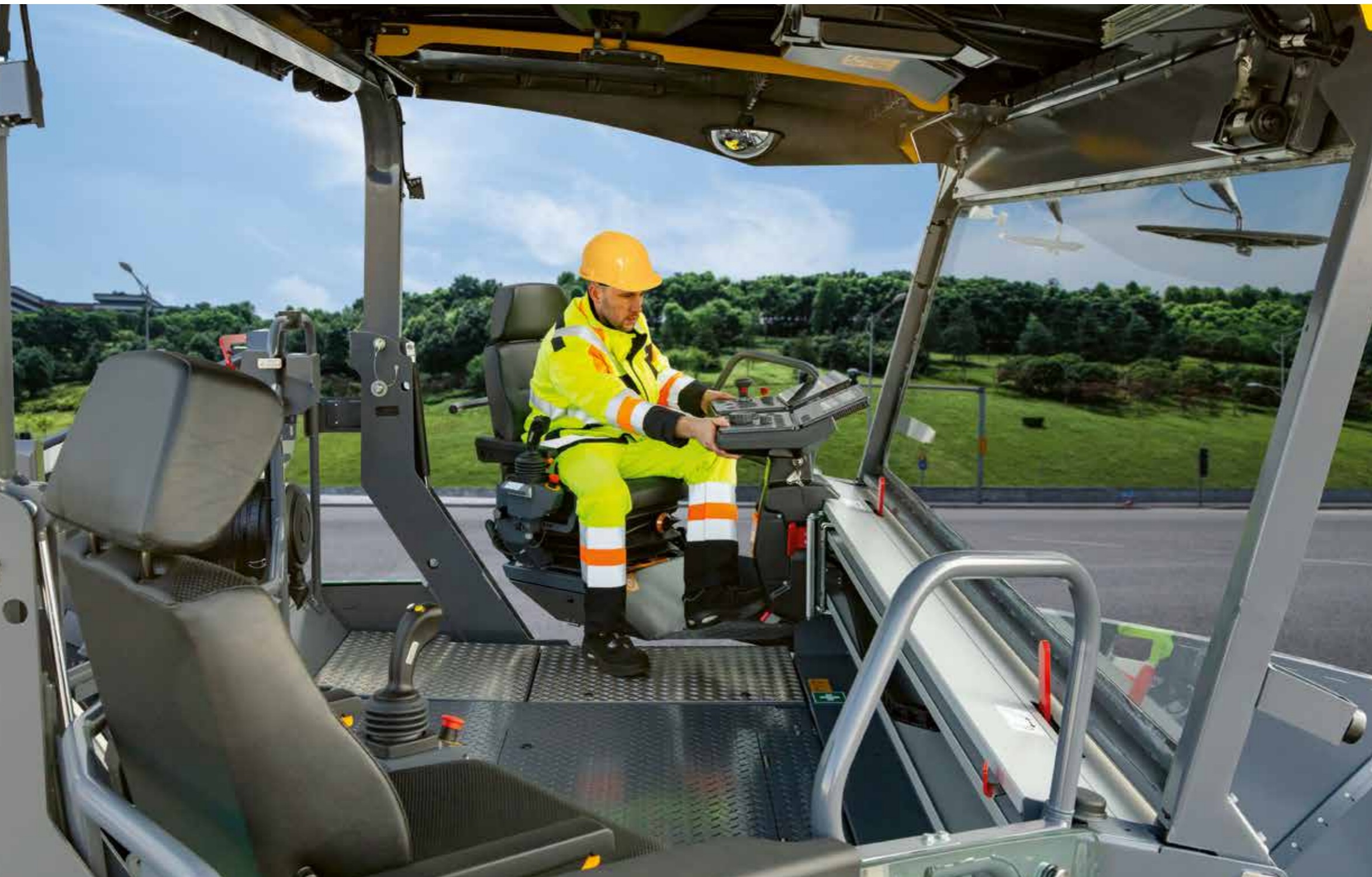
Der komfortable Aufstieg mit Geländer ermöglicht einen sicheren und bequemen Zugang zur großzügigen Bedienplattform.
