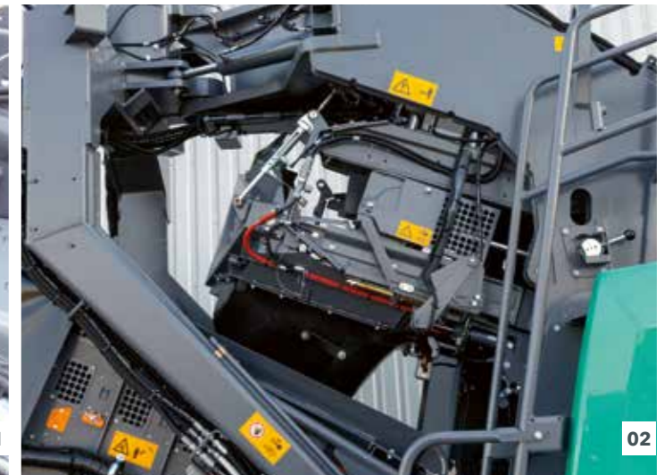
01 Leicht zugängliche Wartungsklappen 02 Klappbarer Übergabetrichter
