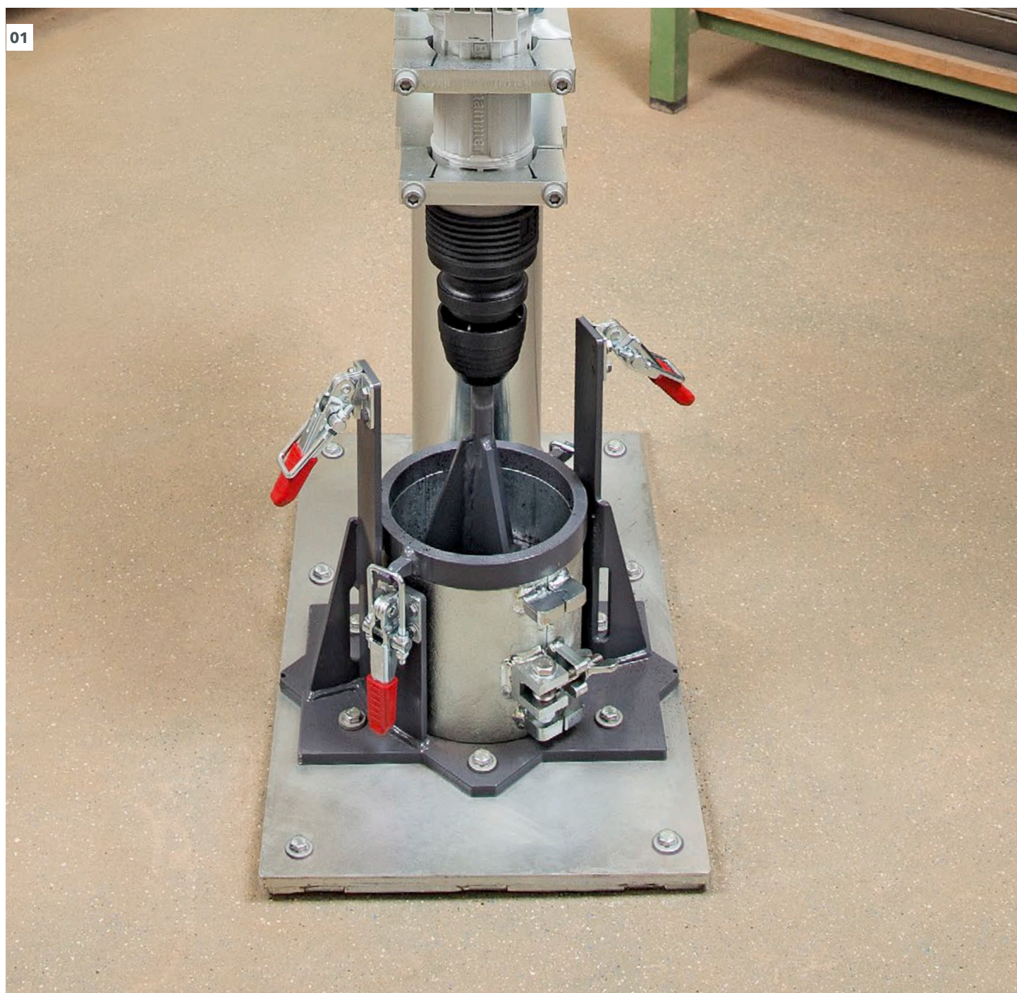
01 - 02 根据不同的检测方法, 高效地制作不同高度的试样。
