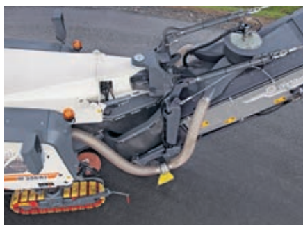
Центробежный вентилятор втягивает мелкие частицы через расположенные по бокам шланги.
