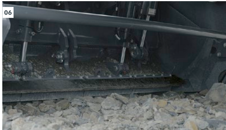
04 粗粒碎石堆积在前门的前方。 05 前门须手动打开，机器前进时，材料被推入破碎和拌合罩壳内。 06 前门闭合，尽量减少向前挤出的材料量。
