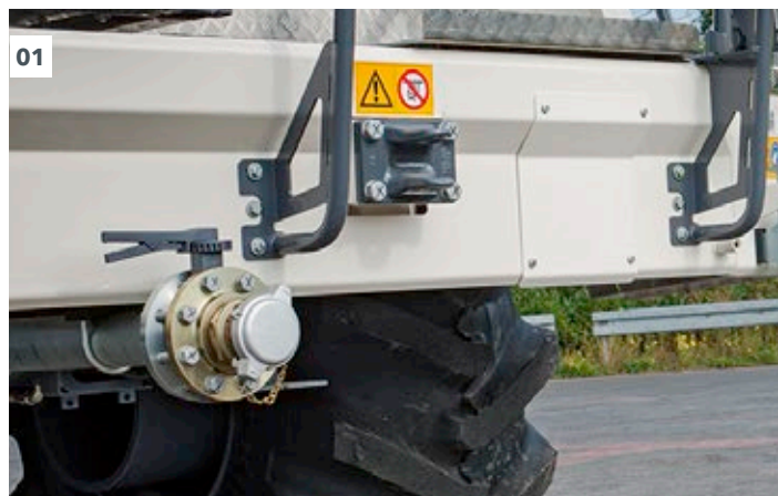
01 所有的连接管都集中布置在前部的横梁上。
