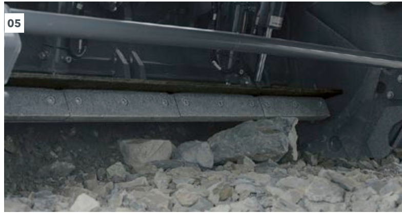
03 固定式和可调式破碎梁的硬质合金边缘破碎梁充当对刃，与 HT18 破碎刀具协同工作，对大块石料加以破碎。
