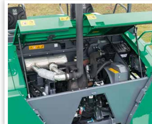
**Potente** motor diesel desenvolve 116 kW a apenas 2000 rpm.
