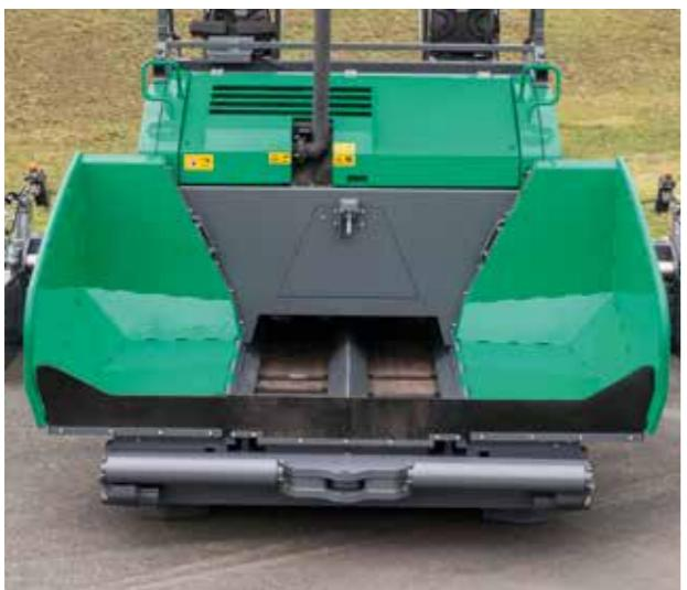
» **A ampla moega de material** de 13 t possui um dimensionamento amplo, de forma que uma quantidade de mistura suficiente seja armazenada em todos os momentos. Não há problema em relação a situações difíceis, como pavimentação por baixo de pontos, por exemplo.
