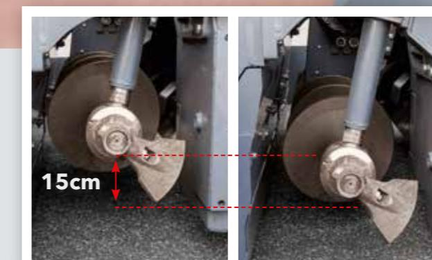
Os trados da SUPER 1600 possuem altura mecanicamente e infinitamente ajustável até 15 cm. Isso permite que eles sejam adaptados à espessura de camada desejada em toda a largura de pavimentação.
