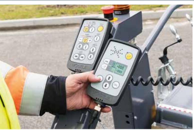
**O novo conceito de operação ErgoBasic** foi desenvolvido com base no comprovado sistema de operação ErgoPlus, mas foi adequado especificamente às necessidades e aos requisitos dos usuários das vibroacabadoras VÖGELE Classic Line.
