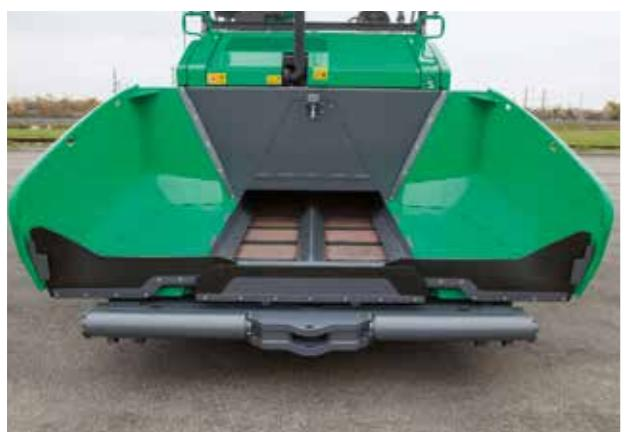
» **La gran tolva receptora** tiene una capacidad de 14 toneladas, por lo que siempre se dispone de suficiente mezcla para el extendido, incluso en las condiciones de alimentación más complejas, por ejemplo, bajo los puentes.
