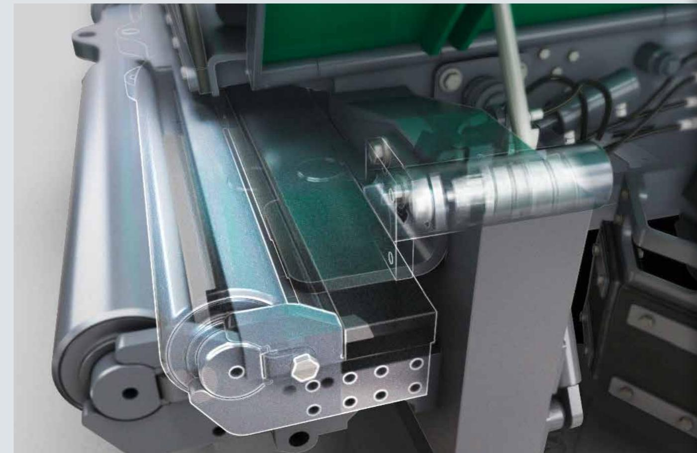
**Alternativamente** al rodillo de empuje montado oscilante, VÖGELE ofrece también "PaveDock", un rodillo de empuje con suspensión elástica. De esta forma, los golpes del camión se compensan de forma todavía más eficiente y segura y no se trasladan al revestimiento extendido.
