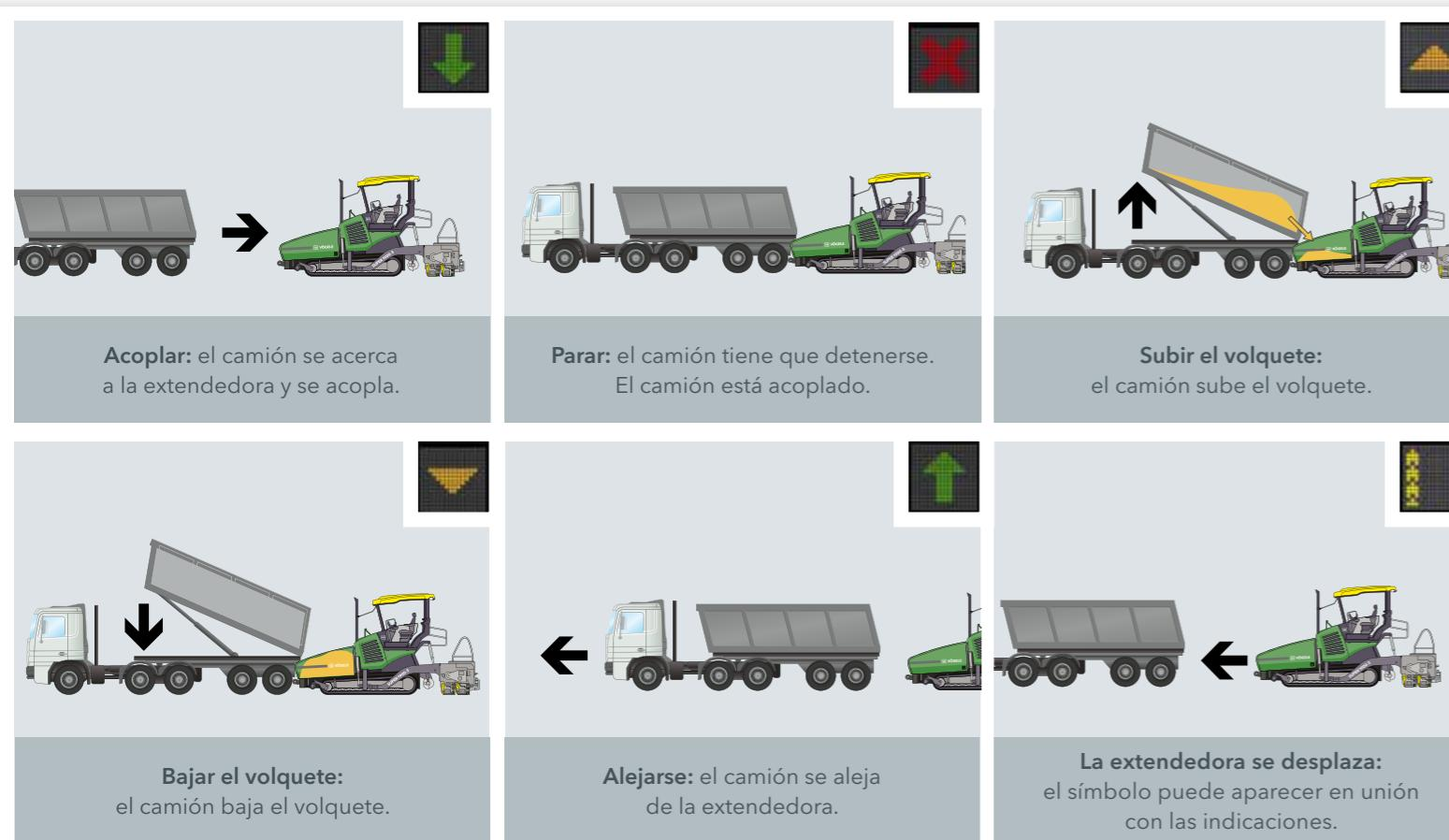
**"PaveDock Assistant"** es el sistema de comunicación entre el conductor de la extendedora y el del camión. Éste hace posible una transferencia de la mezcla a la extendedora especialmente rápida y segura. Elementos esenciales son los semáforos, dispuestos en la extendedora, y los elementos de mando correspondientes, situados en la consola de mando ErgoPlus 3 del conductor.
