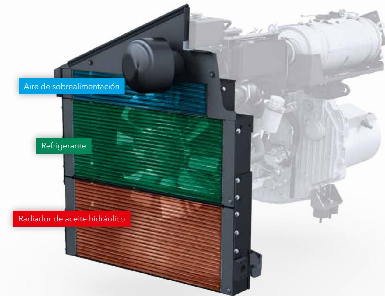
El radiador de múltiples circuitos de grandes dimensiones está subdividido en tres sectores. A través del mismo, el líquido refrigerante del motor, el aire de sobrealimentación y el aceite hidráulico se mantienen a una temperatura óptima.
