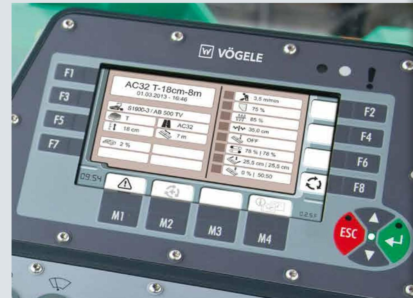
**La función automática** para los programas de extendido hace posible a los operarios crear programas de extendido determinados. De esta forma pueden guardarse todos los parámetros importantes para el extendido en una capa determinada, p. ej. en una capa de base de hormigón asfáltico de 18 cm de espesor.
