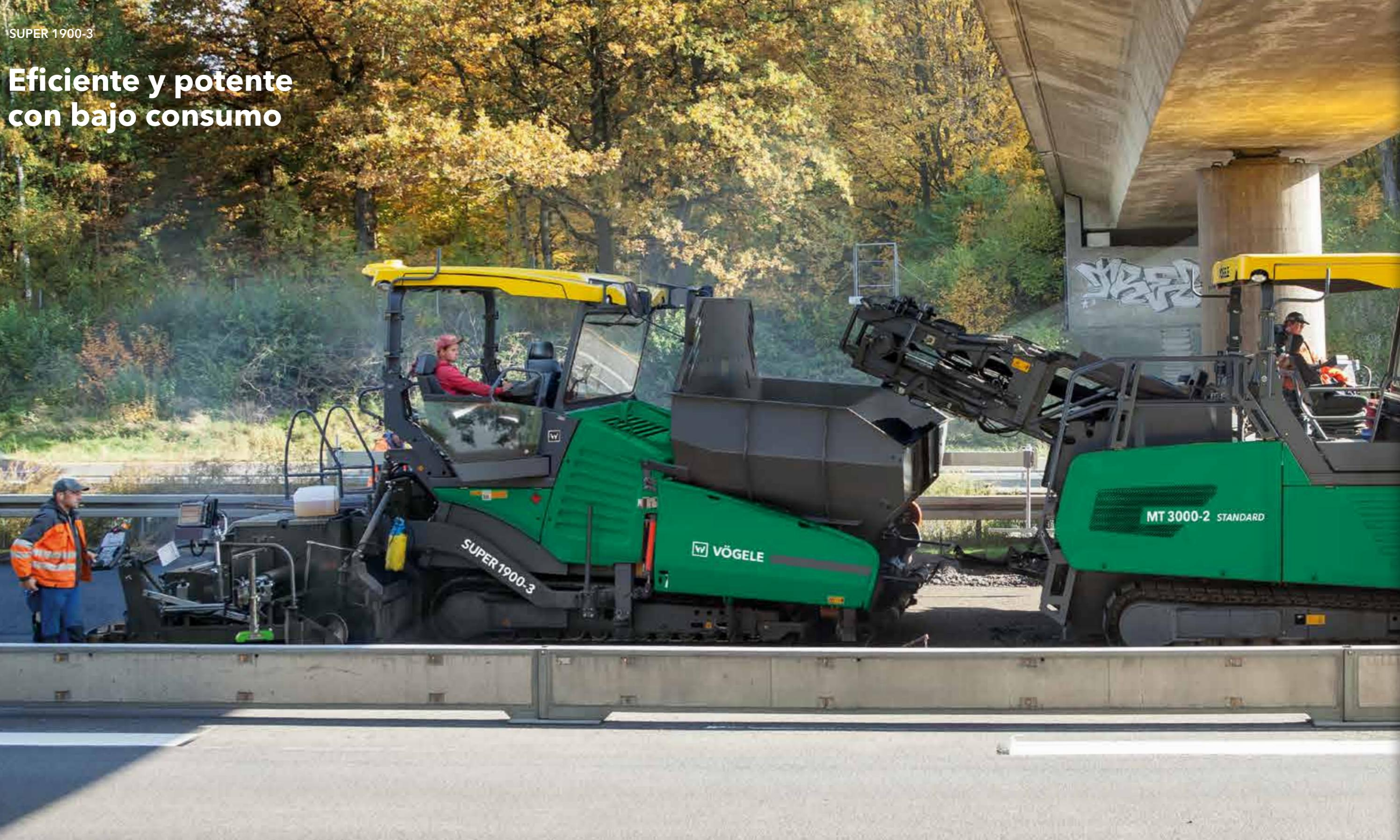
**La fuerza motriz** de la extendedora de la Highway Class es el potente motor diésel de seis cilindros con 151 kW.
