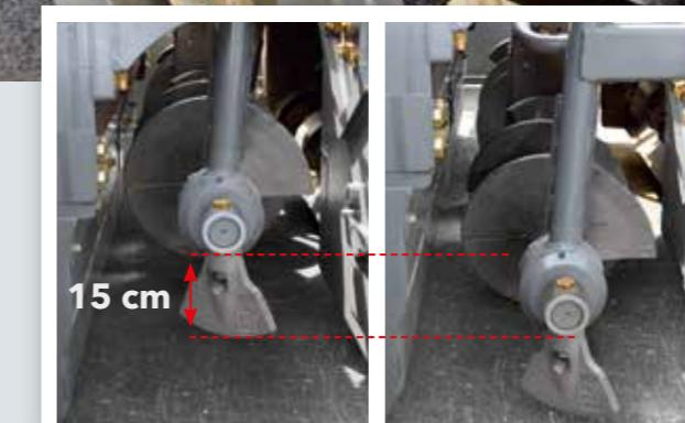
La altura de los sifines de distribución, incluidos los soportes de rodamientos y chapas limitadoras del túnel, puede ajustarse hidráulicamente hasta 15 cm en toda la anchura de extendido. Esto optimiza la distribución de la mezcla, incluso en el extendido de capas finas, así como en diferentes espesores de extendido dentro de un tramo de la obra.
