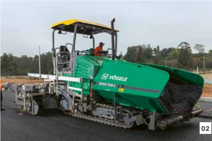
01 ตัวบ่งชี้ฟังก์ชันที่จำกัด จึงไม่จำเป็นต้องมีจอแสดงผล 02 รถปูยางควบคุมการเลี้ยวด้วยตัวควบคุมแบบหมุนเพื่อความสะดวกและความแม่นยำ
