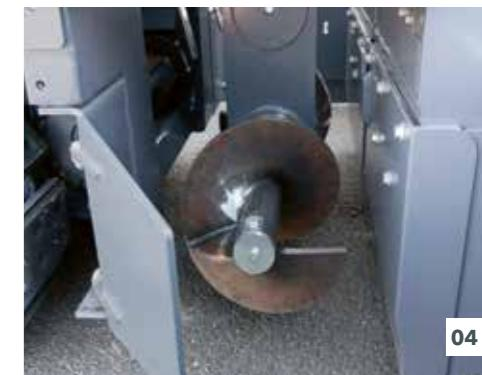
Grazie alla disposizione posteriore della motorizzazione del nastro convogliatore si ottiene una trasmissione ottimale del moto e quindi un'elevata portata a fronte di una contenuta usura del materiale. Il senso di rotazione del nastro convogliatore è reversibile, per cui non vi è nessuna perdita di materiale durante il trasferimento della macchina.
