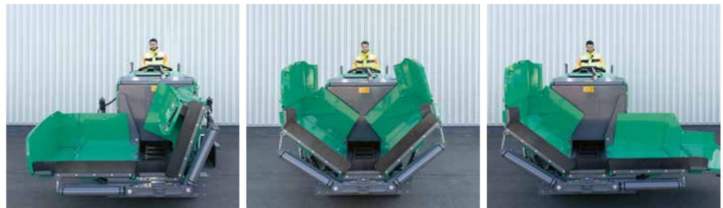
Il cofano motore digradante e la tramoggia ribassata e dotata di una nuova meccanica di ripiegatura e la postazione operatore rialzata ottimizzano notevolmente la visuale.
