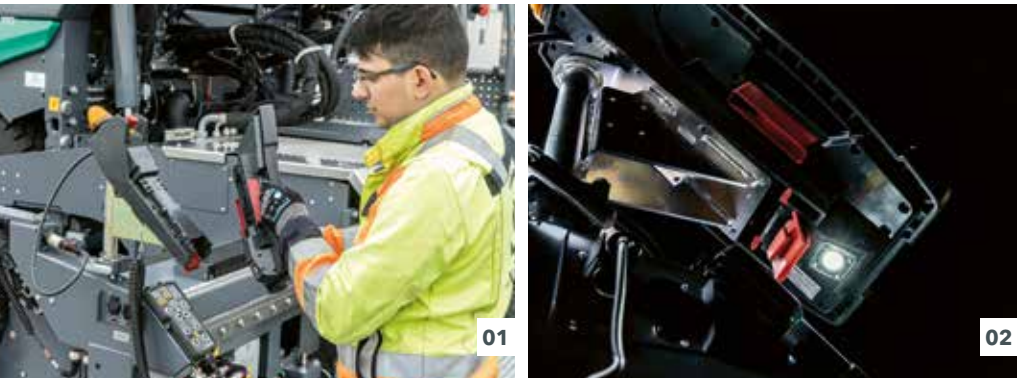
01 Пульт управления для рабочего органа можно подключить во время работы. Благодаря соединителю Quick Connect отпадает надобность в кабеле. 02 На тыльной стороне пульта управления для рабочего органа есть мощный светодиод для подсветки области бокового щита.
