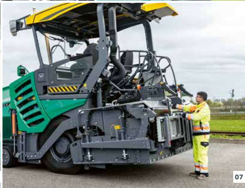
05 Система связи PaveDock Assistant для оптимальной подачи материала. 06 Эргономичное рабочее место с четким и понятным расположением рабочих органов. 07 Безопасная и удобная лестница на рабочем органе.
