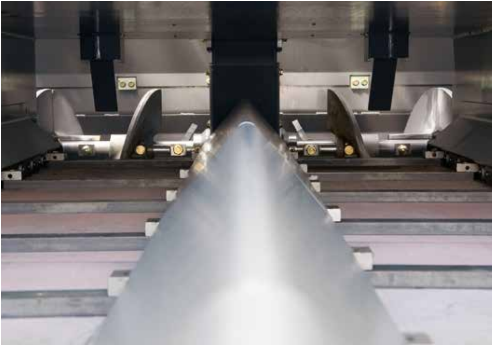
只需按下按键，刮板输料器可进行短时反转。混合料的回送会自动停止。刮板输料器可以快速切换到无负荷运转。
