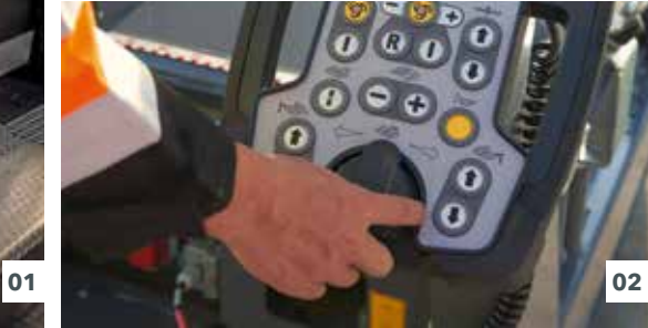
01 高对比度的彩色显示屏，确保了即使在照明不好的工况下，也能理想地读取信息。另外，向下倾斜的大功率 LED 照明灯使机手对边板相关区域拥有良好视野。 02 使用旋钮式熨平板宽度控制开关，准确调节熨平板宽度。
