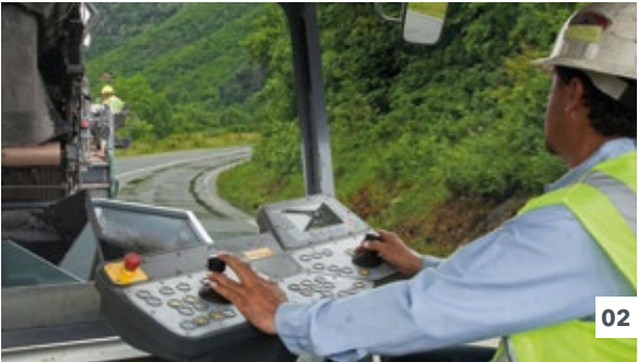
01 Motor diésel con fases del número de revoluciones 02 Dirección con ángulo de dirección preseleccionado 03 Enganche para camión disponible opcionalmente
