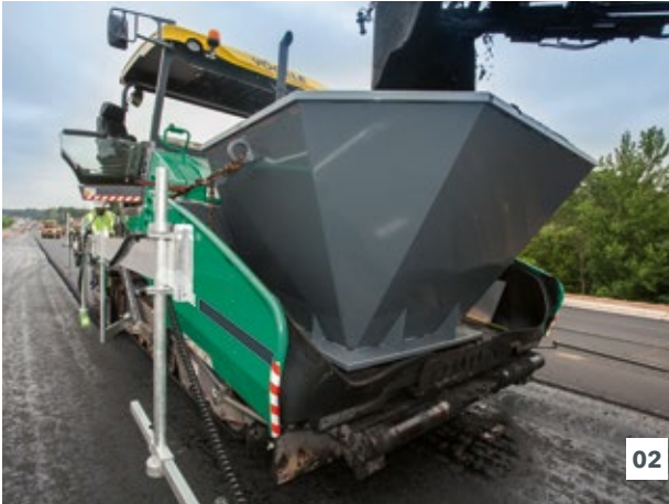
01 Alas de tolva operadas de manera independiente. 02 Está disponible una tolva receptora adicional para la extendidora para suministrar mezcla desde una alimentadora.
