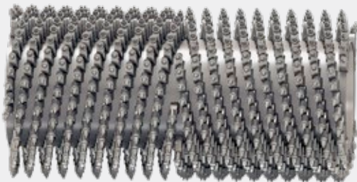
超精铣刨转子 铣刨宽度: 2,000 mm, 铣刨深度: 0–30 mm, 刀间距: 6 x 2 mm
