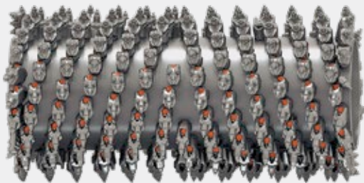
精铣刨转子 铣刨宽度: 2,000 mm, 铣刨深度: 0–100 mm 刀间距: 8 mm
