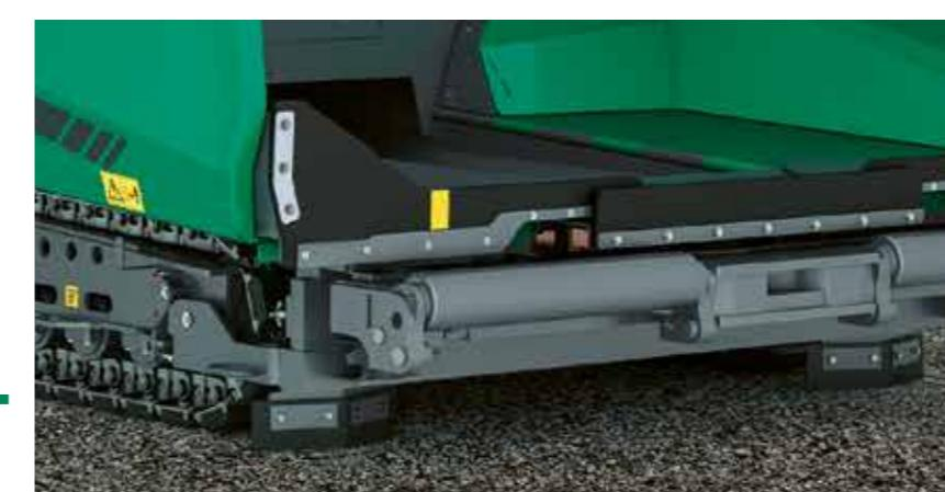
特に幅広の振動式プッシュローラにより、カーブでも揺れのない快適な供給車両への積載を実現しました。プッシュローラは、前後方向に完全に調整することができるので、合材を積載するトラックの形状に合わせることができます。
