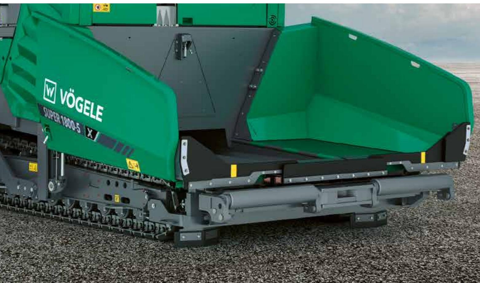
スクリード前方の横方向への合材供給により、あらゆる舗装状況において最適な合材供給が可能です。コンベヤとオーガ用の強力な独立油圧式駆動装置により、最大700トン/時の高い舗装率を実現しました。コンベアとオーガの制御信号が組み合わされ、合材の送り出しを均一にし、合材を安定して供給できます。これにより、負荷ピークを回避するだけでなく、燃料消費量も削減できます。
