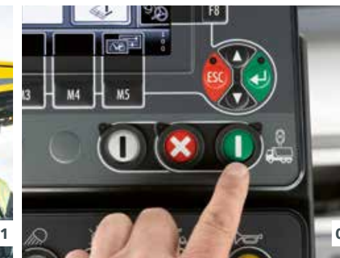
01 ペーバハードトップの左右にある2つの信号灯 02 オペレータコンソールの信号灯の制御
