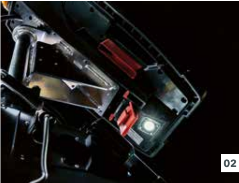
01 スクリードコンソールは、操作中に接続できます。クイックコネクットによって、もうケーブルは必要ありません。 02 スクリードコンソールの背面には、サイドプレートエリアを照らす強力なLEDを搭載しています。
