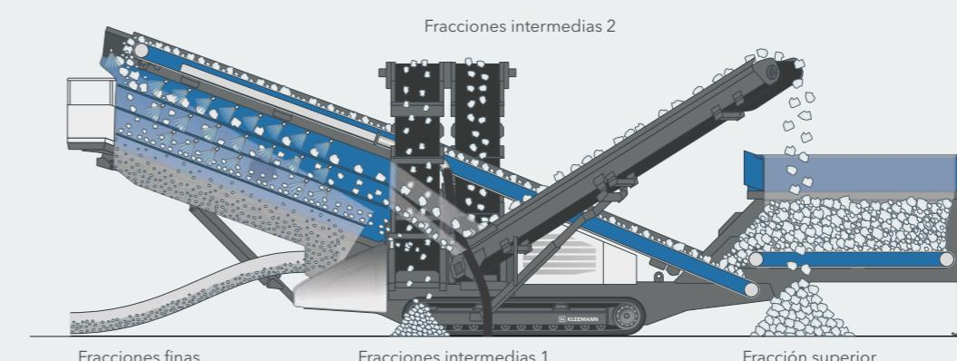
Gracias a unas dimensiones para el transporte compactas, unos tiempos de montaje cortos y una amplia selección de superficie de la criba, la instalación de criba de clasificación MSC EVO puede utilizarse de forma flexible. Para procesar grandes cantidades de forma eficiente, el flujo de material está diseñado de forma óptima: empezando por la tolva de alimentación, que se ensancha en el sentido de flujo del material, pasando por el ancho
