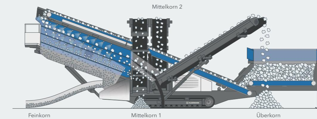
Dank kompakter Transportmaße, kurzen Rüstzeiten und einer großen Auswahl an Siebmedien sind die Klassiersiebanlagen MSC EVO flexibel einsetzbar. Um große Mengen effizient zu verarbeiten, ist der Materialfluss optimal ausgelegt: beginnend beim Aufgabetrichter, der sich in Materialstromrichtung verbreitert, über das breite Aufgabeband bis hin zur großzügig dimensionierten
