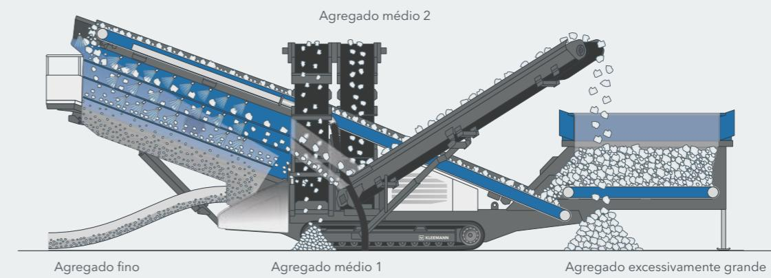
Graças às dimensões compactas de transporte, aos curtos tempos de configuração e a uma grande variedade de telas de peneira, as plantas de peneiramento de triagem MSC EVO podem ser usadas com flexibilidade. Para processar grandes quantidades de forma eficiente, o projeto do fluxo de material foi otimizado: começando na tremonha de alimentação, que se alarga na direção do fluxo de material, passando pela correia
