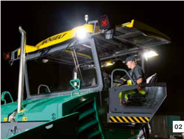
01 Perfeita iluminação da área de trabalho. 02 Perfeita iluminação do posto do operador. 03 Cilindros de nivelamento otimamente iluminados.
