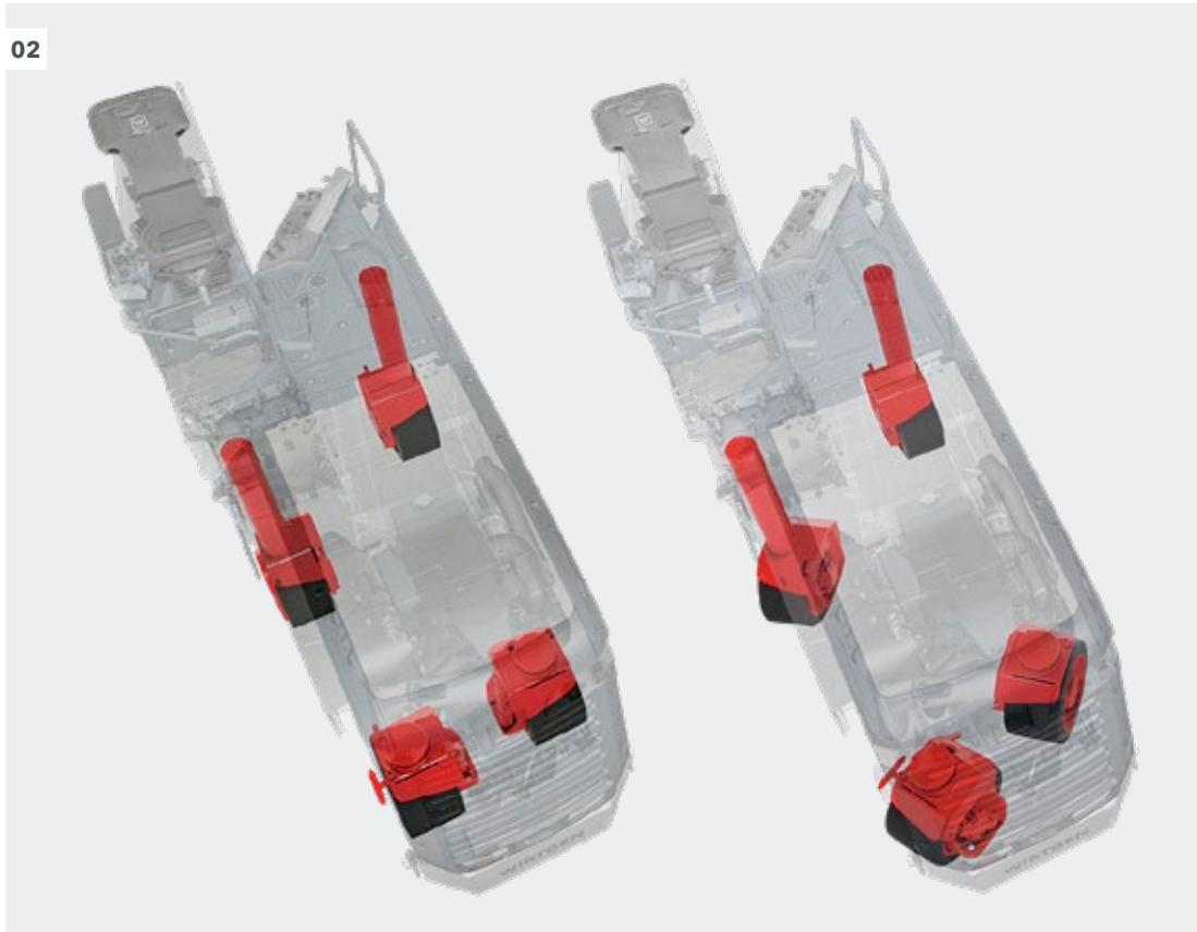
**01** Предельно большой угол поворота колёс облегчает работу на узких строительных площадках.
