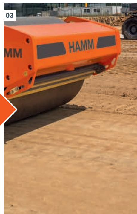
01 - 03 Nella stabilizzazione, il sottofondo non sufficientemente portante viene trasformato in un terreno ben stendibile e compattabile.
