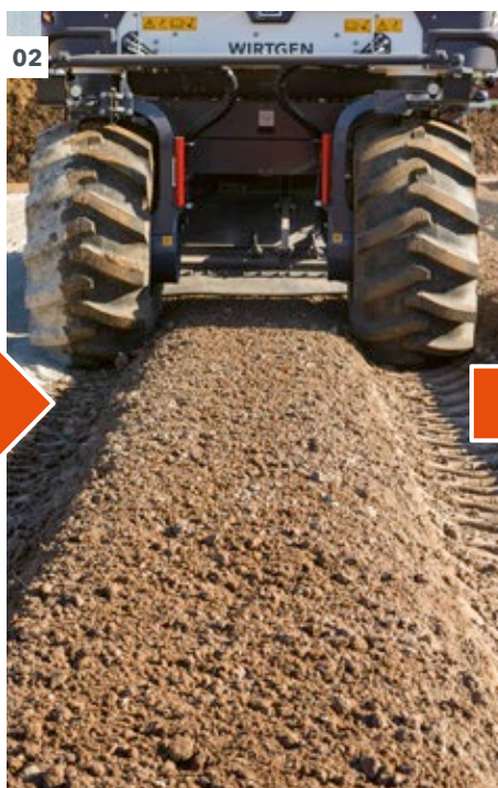
01 - 03 Lors de la stabilisation, des sols supports insuffisamment portants sont transformés en sols facilement intégrables et compactables.
