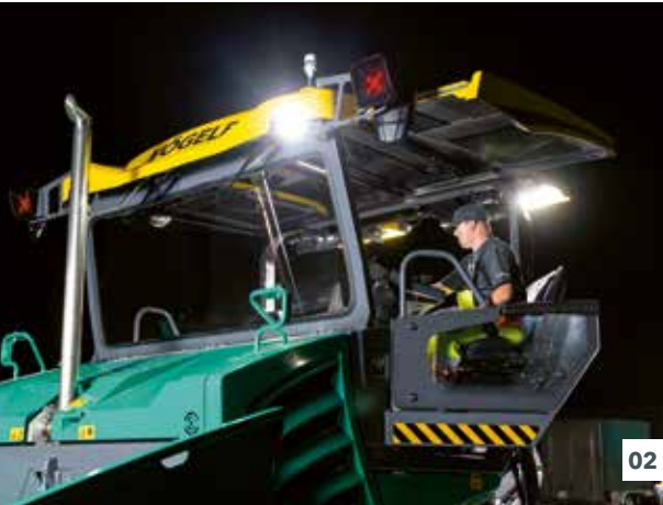
01 Iluminação ideal da área de trabalho. 02 Perfeita iluminação da plataforma do operador. 03 Cilindros de nivelamento otimamente iluminados.
