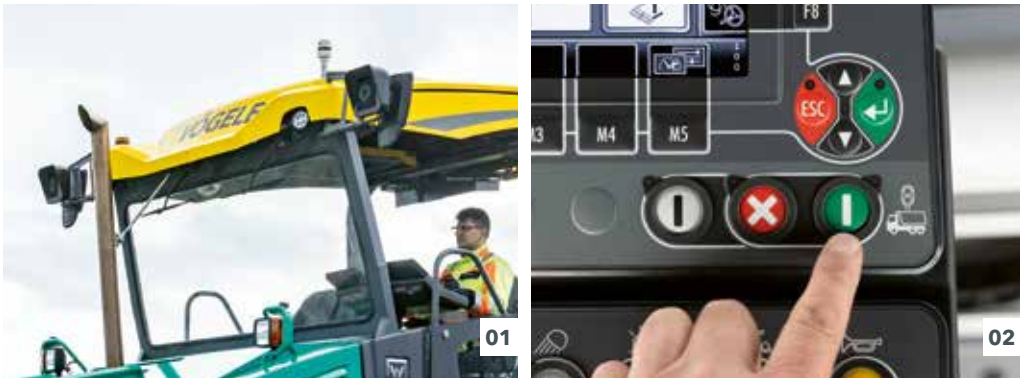
01 As lâmpadas sinalizadoras à esquerda e à direita do teto rígido da vibroacabadora. 02 Elementos de comando das luzes sinalizadoras no console de operação da vibroacabadora.
