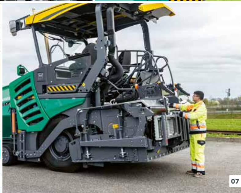
05 Alimentación óptima gracias al sistema de comunicación PaveDock Assistant. 06 Puesto de trabajo ergonómico y claro. 07 Paver Access Control (PAC) para un acceso cómodo y seguro a la extendedora.
