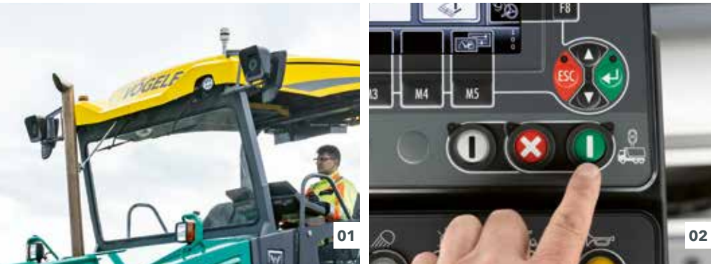
01 Les deux feux de signalisations à gauche et à droite du toit du finisseur. 02 Élément de commande pour le feu de signalisation sur le pupitre de commande du conducteur.
