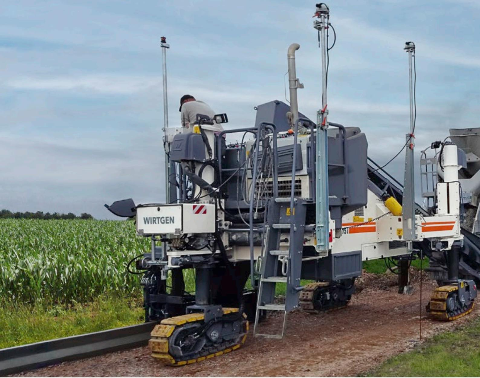
El sistema de control AutoPilot 2.0, diseñado especialmente para máquinas de WIRTGEN, sirve para controlar de forma precisa y sin cable guía determinadas extendedoras de encofrado deslizante y dispositivos adicionales a fin de implementar el extendido automatizado p. ej. de muros de protección de hormigón o perfiles de canal de bordillo.
